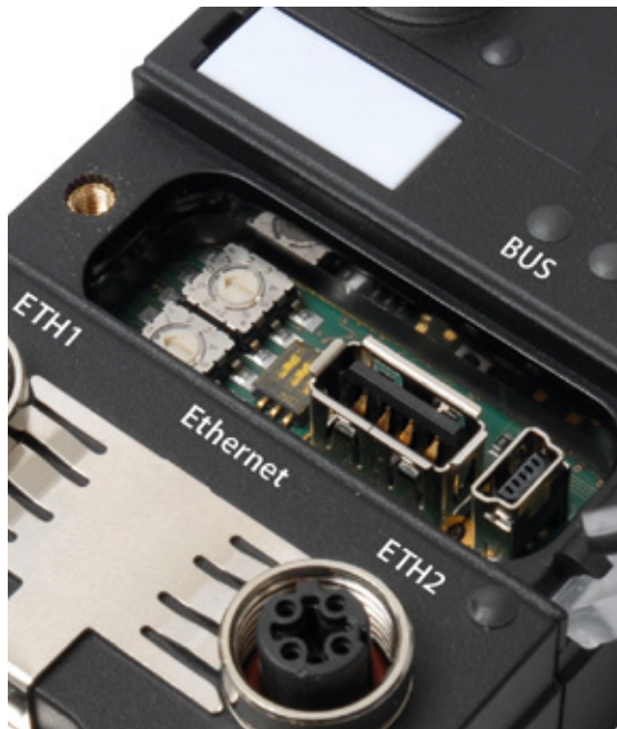
Der USB-Anschluss dient als Speicher-schnittstelle oder zum Übertragen von Daten oder Software auf das Gerät
