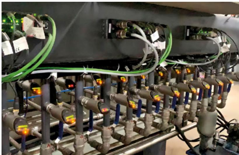
Das um 340° frei drehbare Sensorgehäuse erlaubt die bequeme Ausrichtung von Display und elektrischem Anschluss
