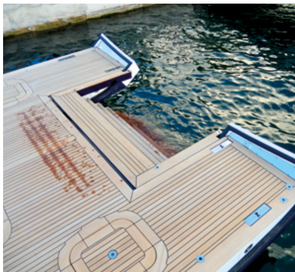
Beim Ausfahren der Schwimmplattform samt Boarding-Leiter erfassen Sensoren die Neigung der Plattform
