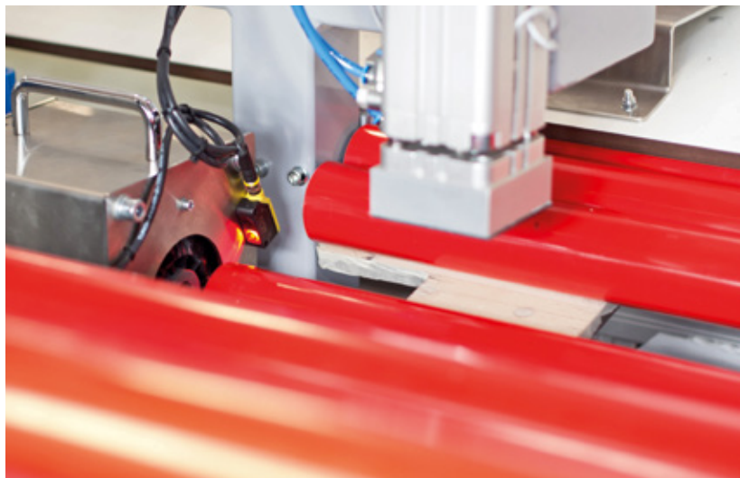
Der Infrarotsensor Q20EQ7 erkennt die Nahtstelle zwischen zwei Rohren
