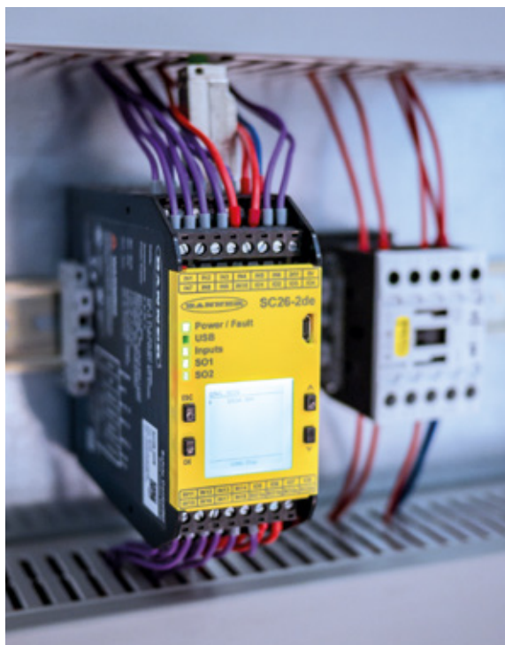
Banners Safety-Controller SC26-2 steuert die Sicherheitsfunktionen der Maschine
