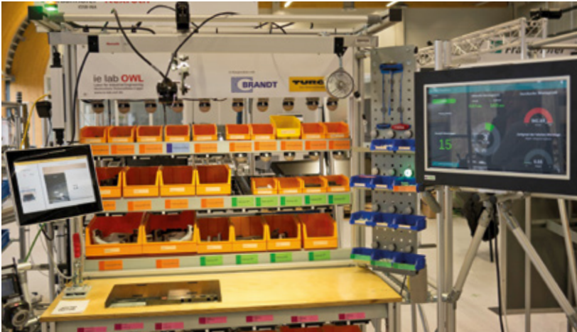
Kontinuierliche Weiterentwicklung: Turcks Pick-to-Light-System wurde jüngst durch das Kennzahlen-Cockpit (rechts) ergänzt
