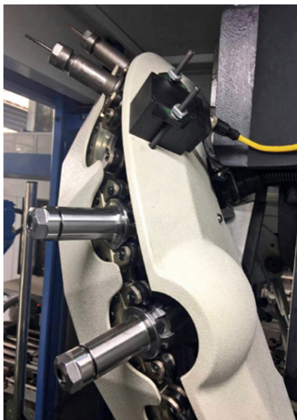
Der RFID-Schreib-Lese-Kopf wird auf der Rückseite des Werkzeugrevolvers angebracht und erkennt den Tag im Werkzeughalter dank seiner hohen Reichweite zuverlässig durch die Verkleidung hindurch
