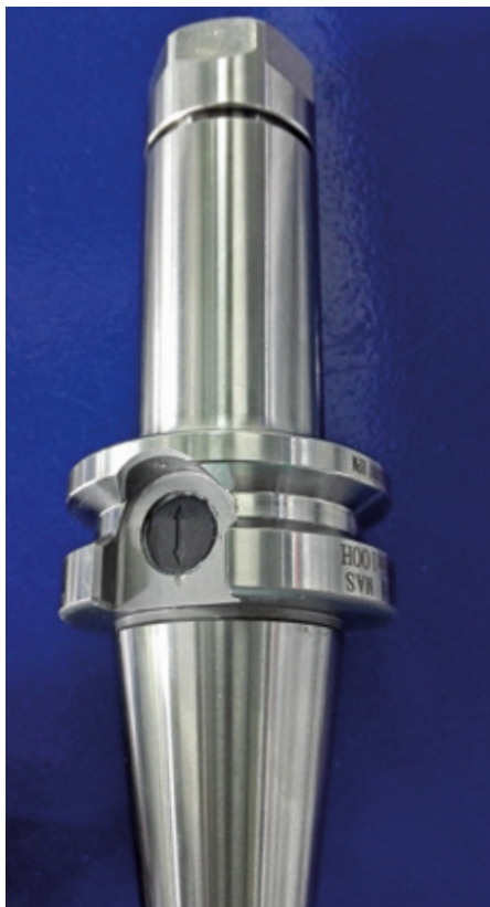
Schneidwerkzeughalter mit eingelassenem RFID-Tag
