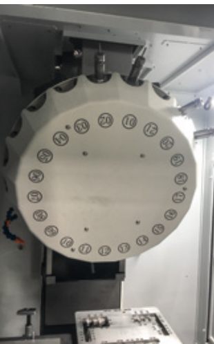
Werkzeugrevolver mit Schneidwerkzeugen
