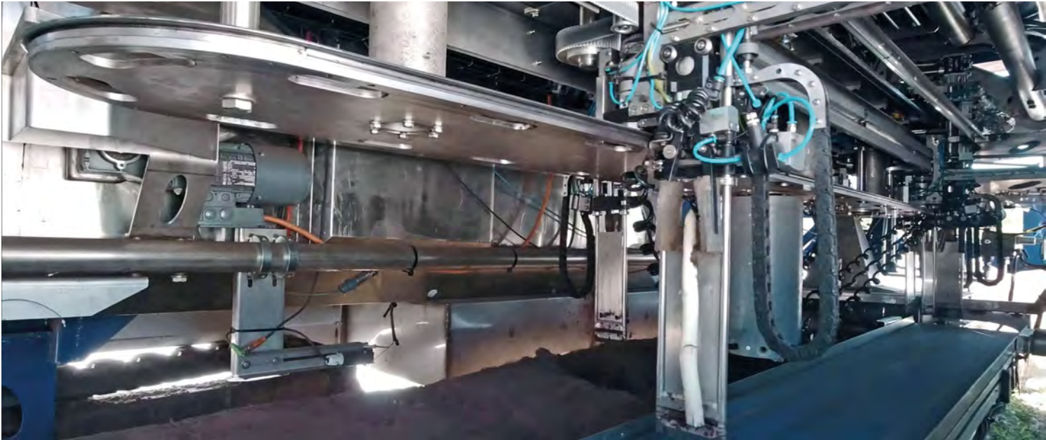
Sechs bis zwölf Erntemodule befinden sich an Bord der Maschine, die Steuerung bringt sie mit Sensordaten an die richtige Stelle
