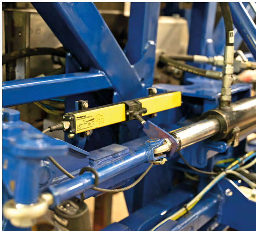
Dank robuster Ausführung und Schutzart IP67 kann der induktive Linearwegsensor LI500-Q25 auch außen, oberhalb der Vorderachse, montiert werden, um die Kolbenposition des Lenkzylinders zu messen
