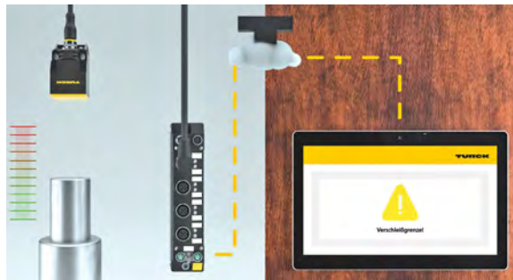
Der induktive Sensor meldet, ob sein Target vom vorgesehenen Schaltabstand abweicht – dies könnte auf Verschleiß deuten
