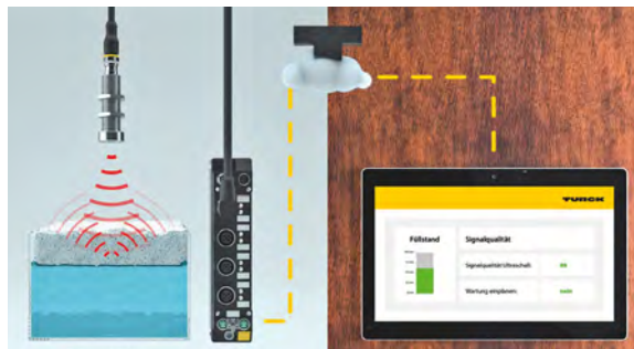
Der Ultraschallsensor liefert neben dem Füllstandswert auch einen Hinweis, wenn sich Schaum auf der Oberfläche bildet
