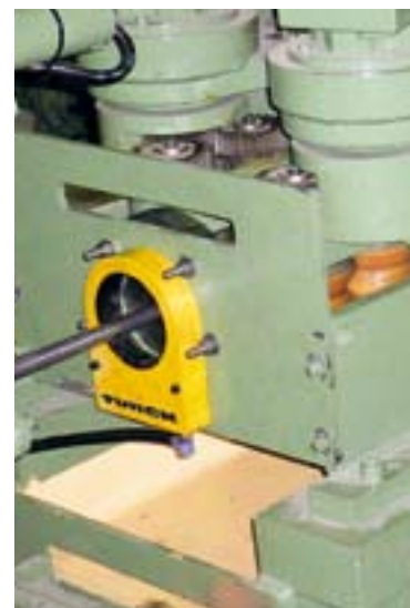
In den Kaltpilgerwalzwerken von SMS Meer erkennt der spezielle Turck-Wirbelstromsensor Material und Durchmesser des Rohres
