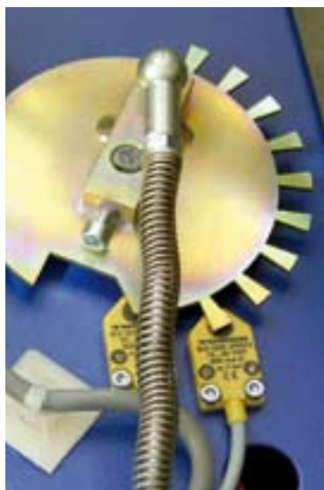
Zigtausend induktive Näherungsschalter von Turck sorgen in den Getränkerücknahme-Automaten von Wincor Nixdorf für Ordnung
