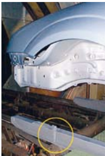
Für Ford entwickelte Turck RFID-Hochtemperaturdatenträger für eine lückenlose Identifikation bis 210 °C – selbst im Brennofen
