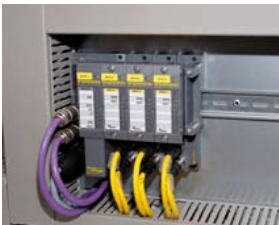
An das BL ident Gateway (links) lassen sich bis zu vier I/O-Module für maximal acht Schreibleseköpfe anschließen
