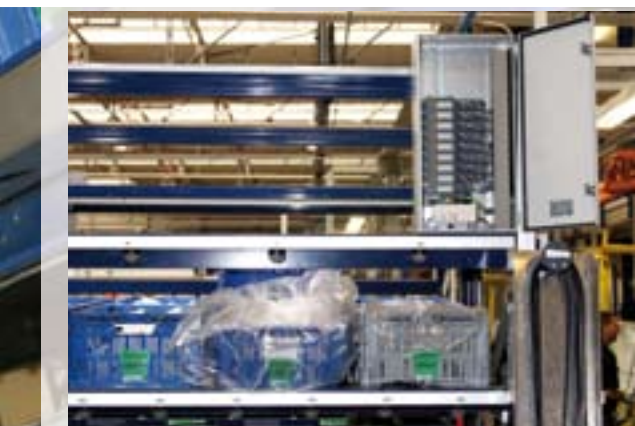
Die Pick-to-Light-Module jeder Picking-Station werden von einer eigenen SPS angesteuert – Turcks I/O-System BL67 sorgt für die sichere Signalübertragung
