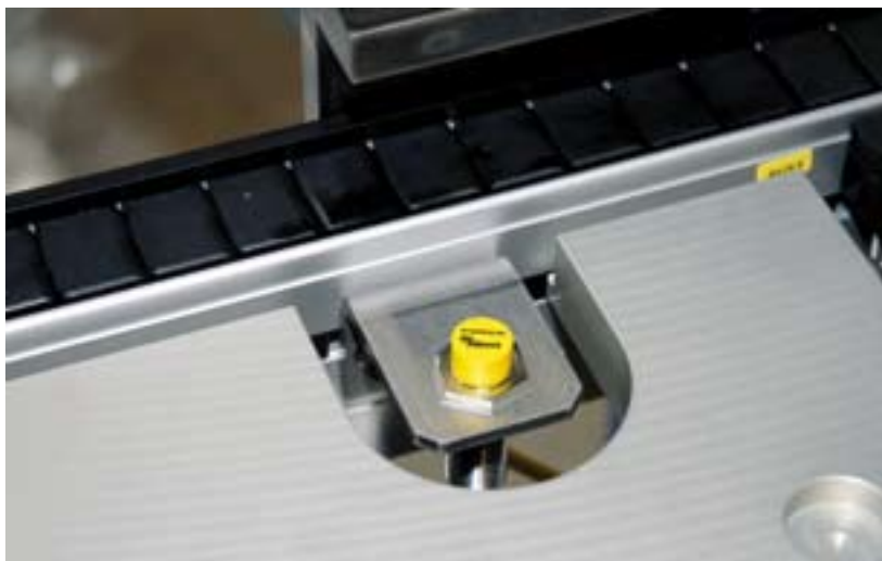
Einfache Montage: Alle Schreibleseköpfe des Turck-RFID-Systems BL ident sind in Standard-Sensorgehäusen untergebracht
