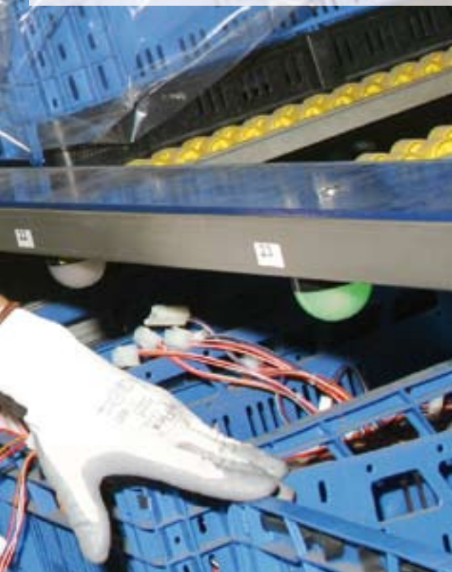
Die Pick-to-Light-Module jeder Picking-Station werden von einer eigenen SPS angesteuert – Turcks I/O-System BL67 sorgt für die sichere Signalübertragung
