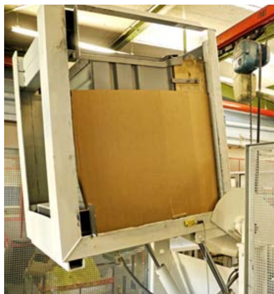
Der Neigungssensor an der Zuführung signalisiert, wenn die Kiste geleert ist
