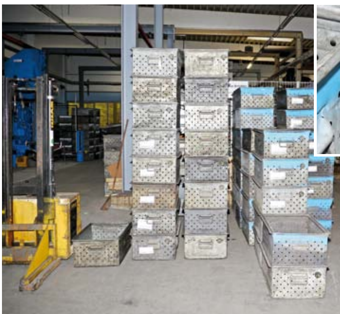
Die RFID-Tags sind mit einem Abstandhalter zuverlässig an den Metallkisten fixiert
