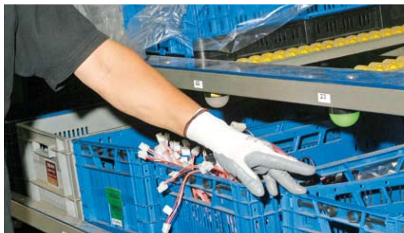
Die LED-Leuchte eines Pick-to-Light-Systems zeigt dem Monteur, aus welchem Fach er das nächste Bauteil entnehmen muss
