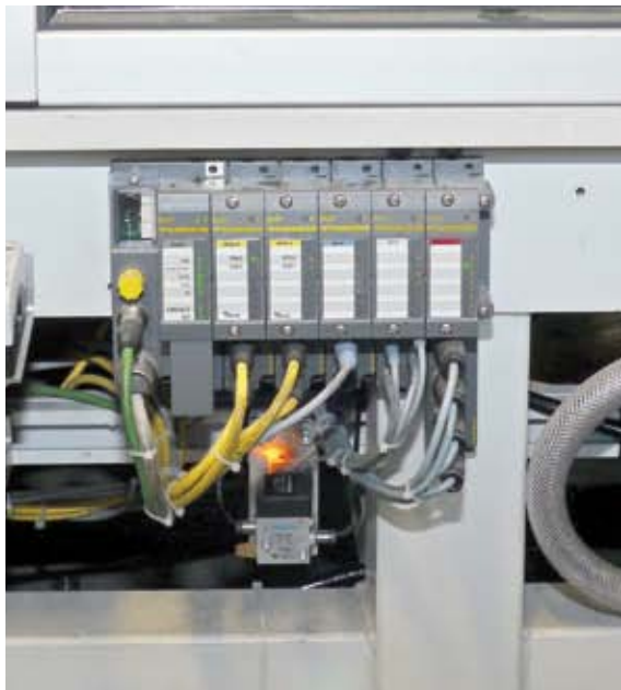
Der Schreibkopf in der Zuführung erkennt, ob die richtige Charge der Strahlanlage zugeführt wird
