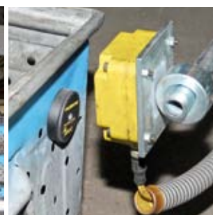
Die RFID-Tags sind mit einem Abstandhalter zuverlässig an den Metallkisten fixiert
