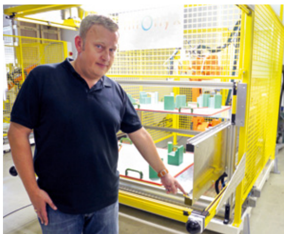
Gerhard Korunka zeigt, worauf es ihm ankam: Schutz bis in die Ecken, ohne gefährliche Überstände
