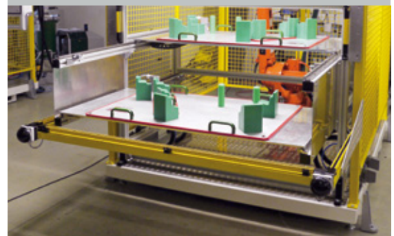
Intronyx sichert Roboterzellen für einen Automobilzulieferer mit Banner-EZ-Screen-Lichtvorhängen aus dem Turck-Programm. Seite 26
