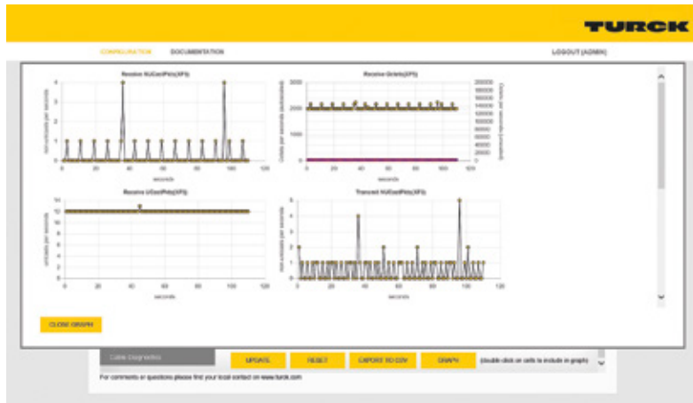
Das Netzlastmonitoring der Switches gibt dem Nutzer stets einen aktuellen Überblick über die Auslastung der Ethernet-Verbindungen
