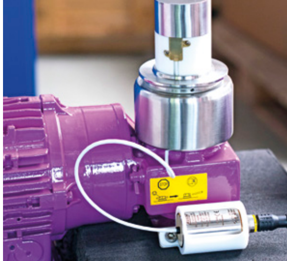
Zwei Hall-Sonden sind im fingernagelgroßen Sensorgehäuse integriert
