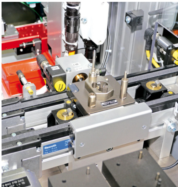
Der Reader liest den Tag am Werkstückträger aus, um die einzelnen Komponenten zu identifizieren
