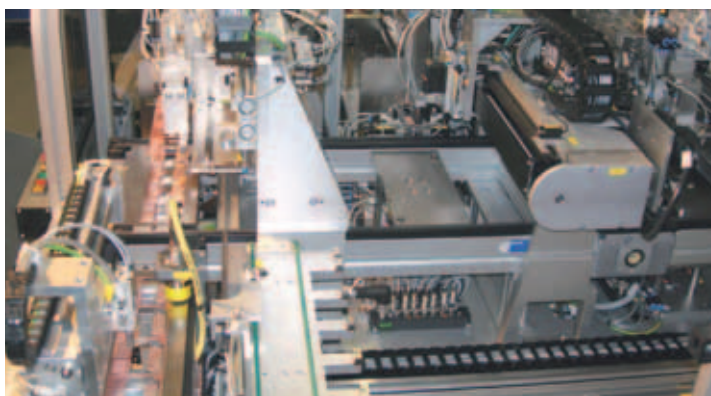
Die Belade- und Entladestation ist das Herzstück der Gefasoft-Anlage
