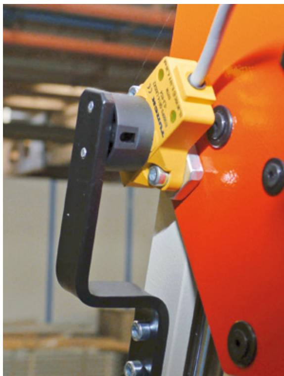
Mit ihrer Auflösung von 0,09 Grad sind Turcks RI-Sensoren mehr als ausreichend genau
