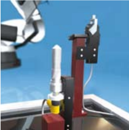
Eine übergestülpte Zentrierhülse aus Edelstahl fixiert die Schweißmuttern und gibt zusätzlichen mechanischen Schutz
