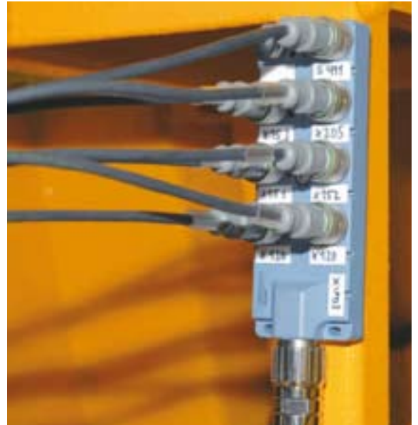
Dichtes Paket: Die Aktor-Sensor-Box mit M12-Push-Pull-Steckverbindungen entspricht Schutzart IP69K
