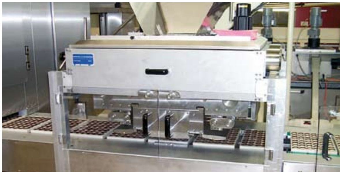
Die RFID-Überwachung schlägt augenblicklich Alarm, wenn eingelegte Formen nicht zur laufenden Produktion passen
