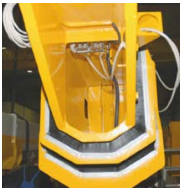
In den Teleskoparmen ist die Verkabelung zwischen Arbeitsbühne und Fahrgestell sicher untergebracht
