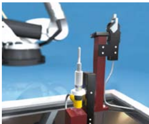
Der Magnetfeldsensor bildet das Herz des „intelligenten Aufnahmebolzens“
