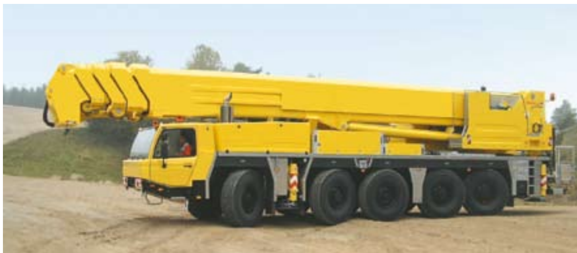
60 Tonnen Power: Das Faun-Kranchassis mit Wumag-Hubarbeitsbühne kann gerade noch ohne Sondergenehmigung im Straßenverkehr bewegt werden
