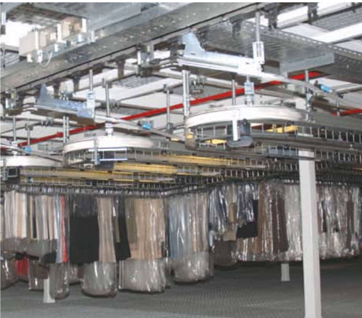
Im Brax-Leineweber-Logistikzentrum sorgt das RFID-System BL ident für Transparenz in der Warenkommissionierung
