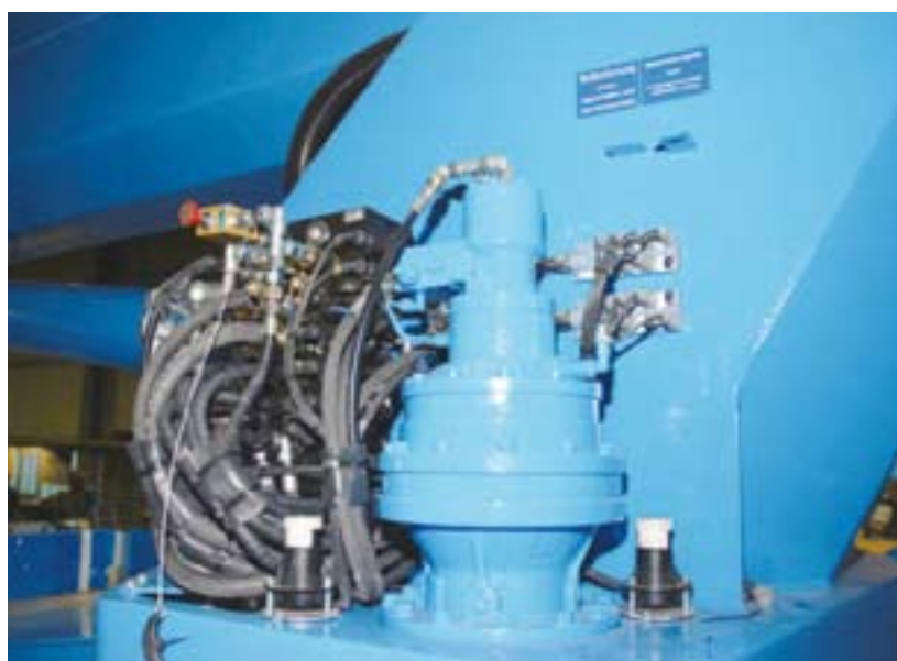
Notbedienung am Gerätesteuerblock: Die Aktor-Sensor-Boxen trotzen Wind und Wetter ebenso wie Temperaturen zwischen -20 und +80 °C
