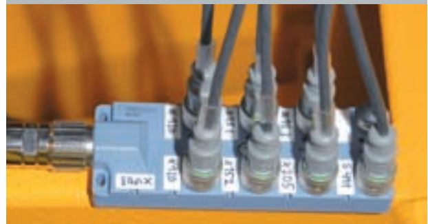
Extrem dicht sind die Aktor/Sensor-Boxen mit Schnellstecksystem auf Wumag-Hubarbeitsbühnen Seite 32
