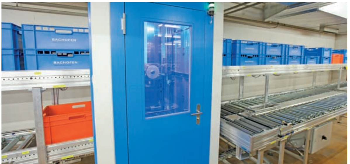
Vor dem Kleingüteraufzug liest ein Schreiblesekopf die Zieldaten aus dem Datenträger unter den Boxen
