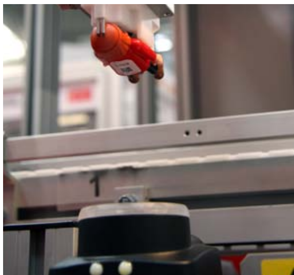
Der DataMatrix/Barcode-Reader aus der Banner- iVu-Familie liest den Code vom Figurenrücken
