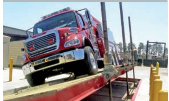
In den USA garantiert Ferrara Fire Apparatus die Stabilität ihrer Fahrzeuge mit einem statischen Kipptest – Neigungssensoren von Turck erfassen den Winkel. Seite 40
