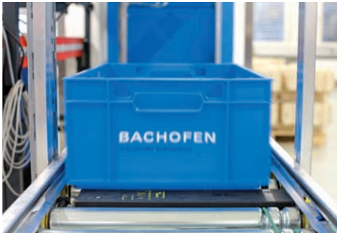
Pro Etage erfassen drei spezielle Q80-Schreibleseköpfe für Rollenbahnen die unter den Transportbehältern angebrachten Datenträger – berührungslos und zuverlässig
