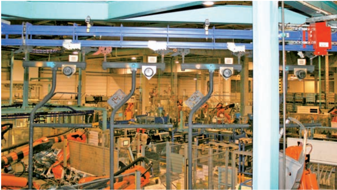
Bis heute werden in der Regel die Transportsysteme per RFID-Datenträger identifiziert, wie hier die Gehänge beim Zulieferer Tower Automotive
