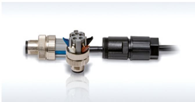
Neu im Connectivity-Portfolio sind konfektionierbare M12-Steckverbinder mit integrierter Push-In-Anschlusstechnologie. Die Technologie ermöglicht dem Anwender eine werkzeugfreie sowie schnelle und sichere Handmontage. Weder LötKolben noch Schraubendreher sind notwendig. Zur Inbetriebnahme steckt der Kunde lediglich ein abisoliertes Einzeladerende in den gewünschten Kontaktbereich und stellt durch die mechanische Verriegelung gleichzeitig die elektrische Kontaktierung her.
