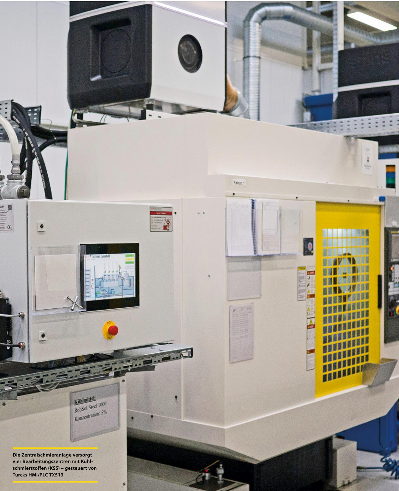
Die Zentralschmieranlage versorgt vier Bearbeitungszentren mit Kühlschmierstoffen (KSS) – gesteuert von Turcks HMI/PLC TX513
