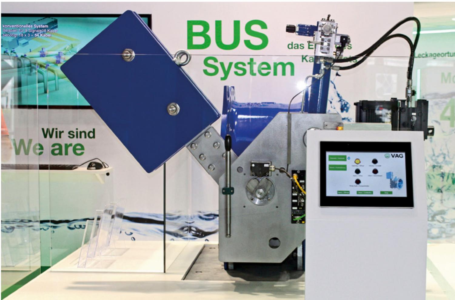
Signal an die Steuerung der HYsec. Daraufhin pumpt das Hydraulikaggregat kein Öl mehr in den Hydraulikzylinder; die Anlage ist somit drucklos. Das hydraulische Fallgewicht löst aus und verschließt das Rohr, sodass kein Wasser mehr ausströmen kann. Wenn der Rohrbruch behoben ist, steigt der Druck in der HYsec und die Pumpe versorgt den Hydraulikzylinder wieder mit Hydrauliköl. Dadurch wird das Fallgewicht angehoben, die Armatur öffnet und das Wasser kann wieder fließen.
