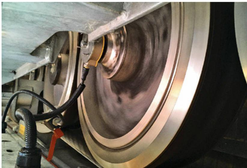
Der QR24-Drehgeber zählt die Umdrehungen der Hohlkehlrollen und sendet die Daten an eine Steuerung
