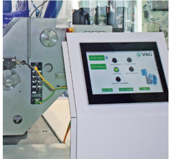
Das I/O-Modul TBEN-L und das HMI TX513 steuern und visualisieren die Vorgänge der HYsec
