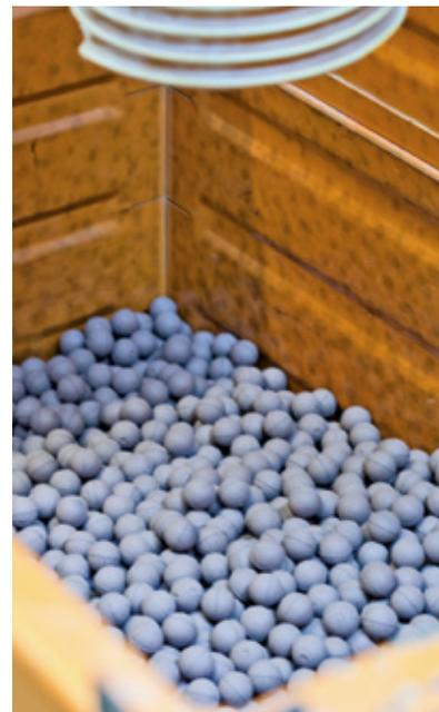
Die Reinigungskugeln aus Naturkautschuk sind je nach Einsatzgebiet verschieden aufgebaut: sie erreichen Durchmesser von 14 bis 48 Millimeter
