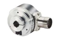
Singleturn-Absolutwert-Drehgeber erfassen jeden Winkel innerhalb einer 360°-Umdrehung. Da bei absoluten Drehgebern jedem Winkelschritt ein eindeutiges Codemuster zugeordnet ist, kann die Position auch nach einem Stromausfall jederzeit ohne ein Referenzverfahren erkannt werden. Die Stärken der Absolutgeber liegen in der exakten Erfassung von Winkeln, Positionen und Neigungen, z.B. in der Robotik, Positionier- und Verfahrenstechnik.
