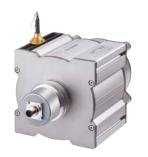
Für die direkte Längenmessung sind Drehgeber mit vorgesetzten Seilzügen (in 0,25 bis 40 m Länge) die richtige Lösung. Mit einer Wiederholgenauigkeit bis zu 0,05 mm erlauben die Turck-Geräte die exakte Positionierung in Applikationen, die bisher nur durch komplexe Systeme zu lösen waren.
