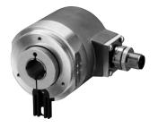
Multiturn-Absolutwert-Drehgeber erfassen jeden Winkel innerhalb einer 360°-Umdrehung und darüber hinaus auch die Anzahl der Umdrehungen. Da bei absoluten Drehgebern jedem Winkelschritt ein eindeutiges Codemuster zugeordnet ist, kann die Position auch nach einem Stromausfall jederzeit ohne ein Referenzverfahren erkannt werden.
