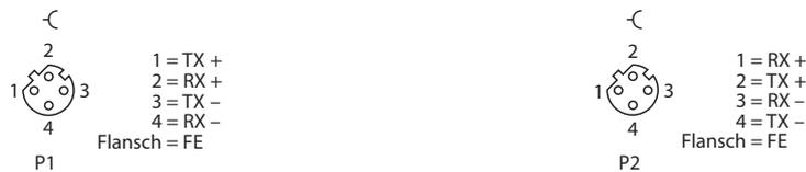
Abb. 16: Pinbelegung Ethernet-Anschlüsse
