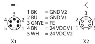
Abb. 18: TBEN-L5... – Pinbelegung
