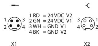
Abb. 17: TBEN-L4... – Pinbelegung
