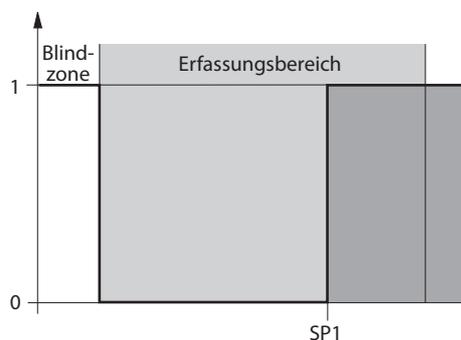
Abb. 4: Reflexionstaster mit Öffnerfunktion – Verhalten des Schaltausgangs
