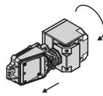
Abb. 21: Optional: Umsetzwinkel abnehmen und um 180° drehen
