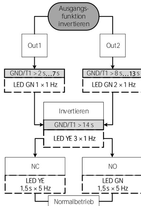
Abb. 58: Ausgangsfunktion invertieren (Schließer/Öffner)
