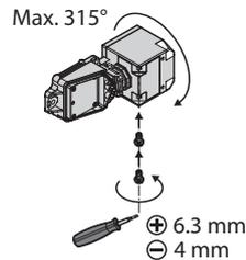
Abb. 22: Optional: Schrauben am Sensor befestigen
