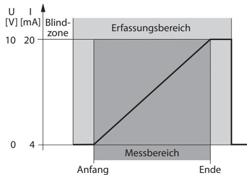
Abb. 8: Analogausgang – Ausgangsverhalten
