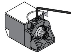
Abb. 17: Sensor in Befestigungsschelle stecken und Sicherungsschraube anziehen
