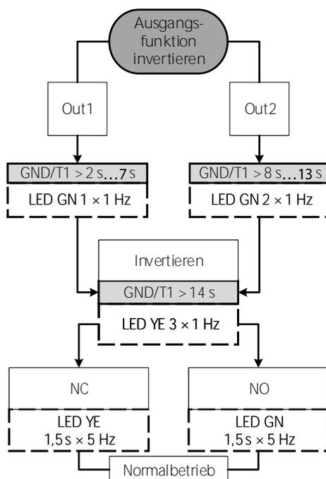
Abb. 41: Ausgangsfunktion invertieren (Schließer/Öffner)
