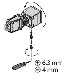
Abb. 20: Optional: Schrauben am Sensor lösen
