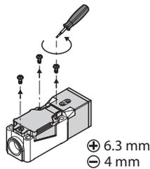
Abb. 18: Sicherungsschrauben lösen
