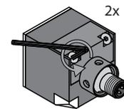
Abb. 14: Schrauben am Sensor lösen
