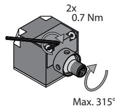
Abb. 16: Schrauben am Sensor befestigen und Steckverbinder ausrichten
