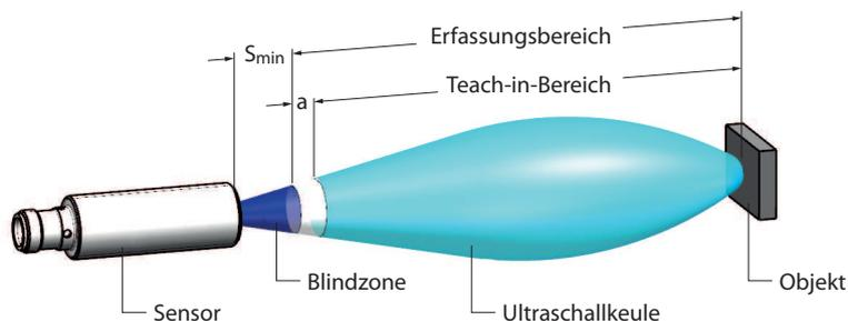
Abb. 37: Schallkeule und Ausbreitung der Blindzone (schematisch)
