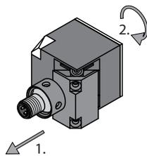
Abb. 15: Umsetzwinkel abnehmen und um 180° drehen
