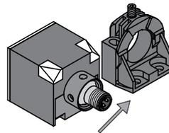
Abb. 13: Sensor aus Befestigungsschelle ziehen
