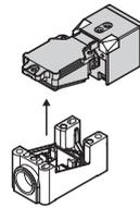
Abb. 19: Sensor aus dem Anschlusssockel ziehen
