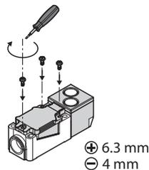
Abb. 24: Sensor in den Anschlusssockel stecken und Sicherungsschrauben anziehen
