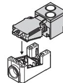
Abb. 23: Steckverbinder ausrichten
