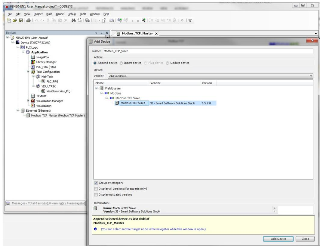
Fig. 30: CODESYS – adding the Modbus TCP slave
