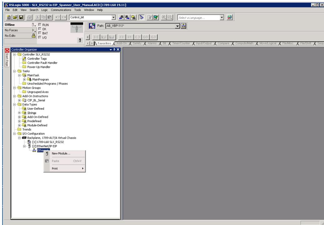
Fig. 44: RSLogix – adding a new module
