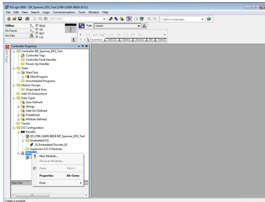
Fig. 54: RSLogix – New Module
