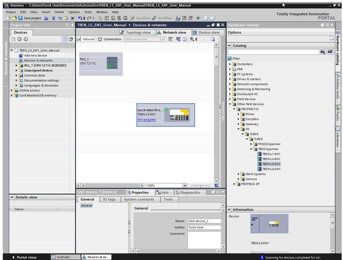
Fig. 62: TIA-Portal – adding the spanner module
