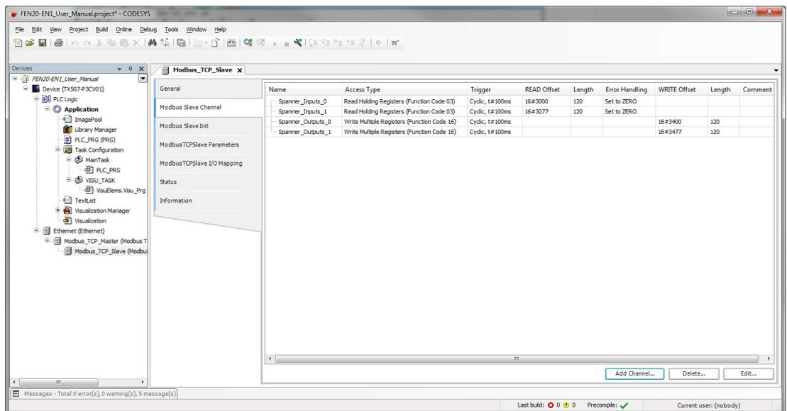
Fig. 33: CODESYS – Modbus TCP Slave channels
