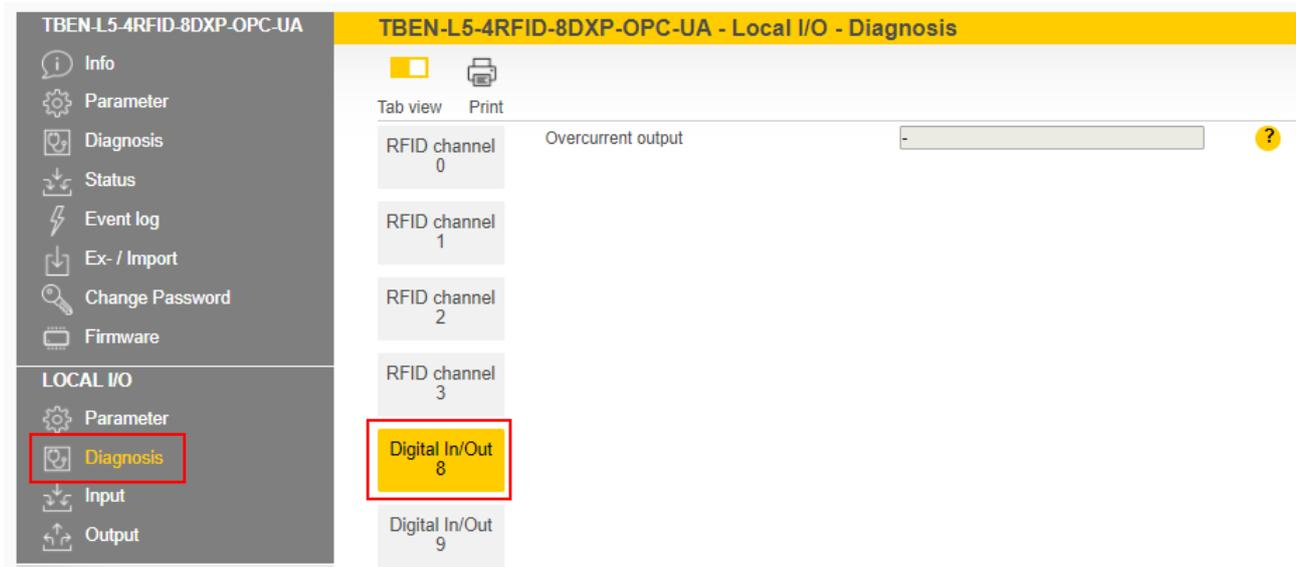
Abb. 83: Webserver – Diagnosen DXP-Kanäle
