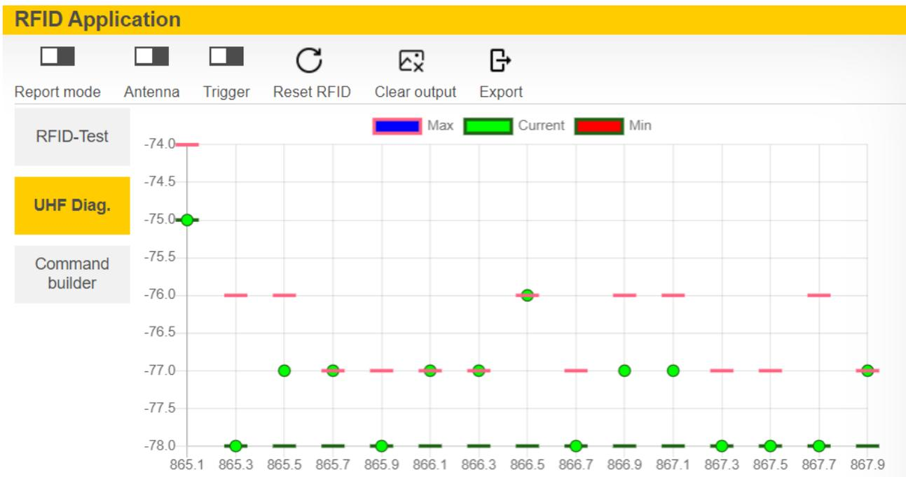
Abb. 74: Beispiel UHF-Diagnose: empfangener Leistungspegel pro Kanal
