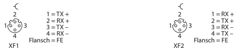
Abb. 17: Pinbelegung Ethernet-Anschlüsse
