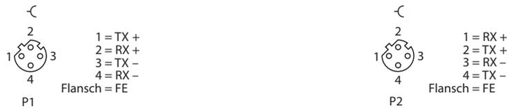
Abb. 15: Pinbelegung Ethernet-Anschlüsse
