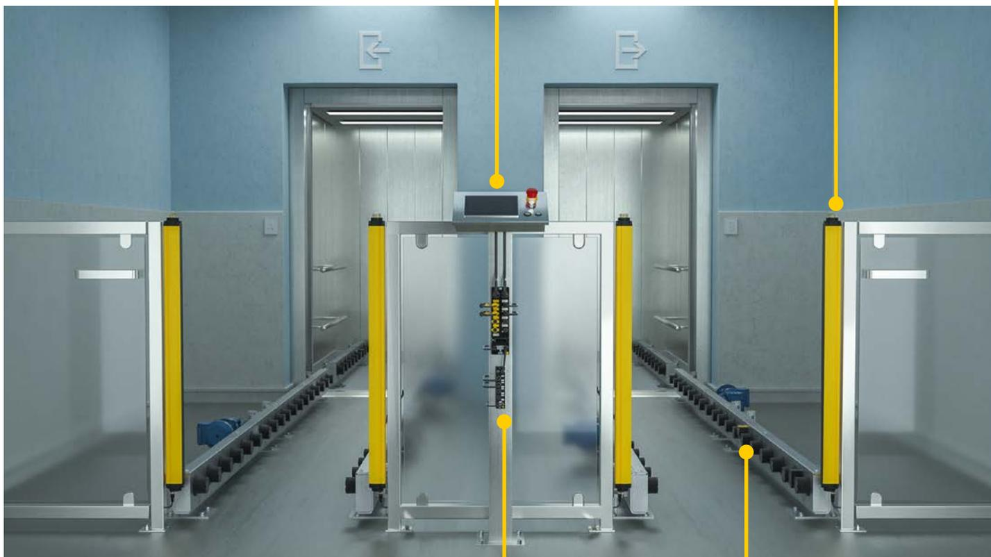
Das RFID-System BL ident® sorgt für hohe Anlageneffizienz und Nachverfolgbarkeit der Container durch zuverlässige Funkidentifikation. Das System besteht aus Schreib-Lese-Köpfen, RFID-I/O-Modulen und anwendungsoptimierten Datenträgern, auch zur direkten Montage auf Metall.
