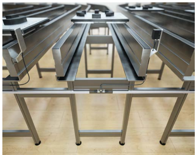
Förderlinie mit busfähigem Schreib-Lese-Kopf und T-Verteiler zum Aufbau der Linientopologie
