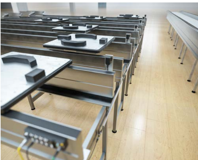
Gleichzeitige Identifikation von Werkstückträgern an parallelen Förderlinien
