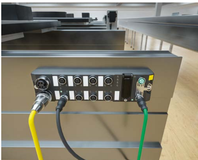
Anbindung von bis zu 32 busfähigen Schreib-Lese-Köpfen an einem RFID-Kanal
