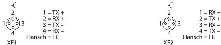
Abb. 10: Pinbelegung Ethernet-Anschlüsse
