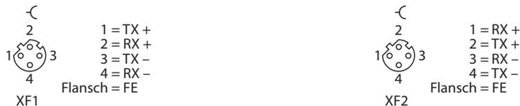
Abb. 14: Pinbelegung Ethernet-Anschlüsse
