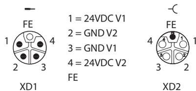
Abb. 15: Pinbelegung Versorgungsspannungsanschlüsse
