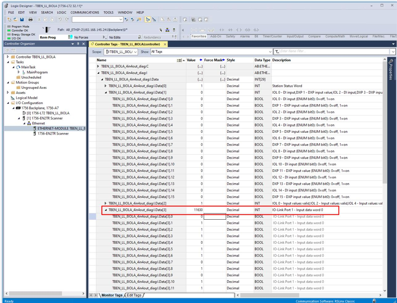
Abb. 68: Controller Tags im Projektbaum – IO-Link-Daten an IO-Link-Port 1
