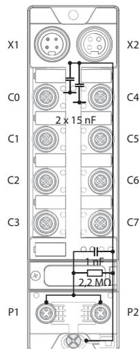
Abb. 6: TBEN-L4-8IOLA – Ersatzschaltbild und Schirmungskonzept
