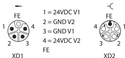
Abb. 15: Pinbelegung Versorgungsspannungsanschlüsse
