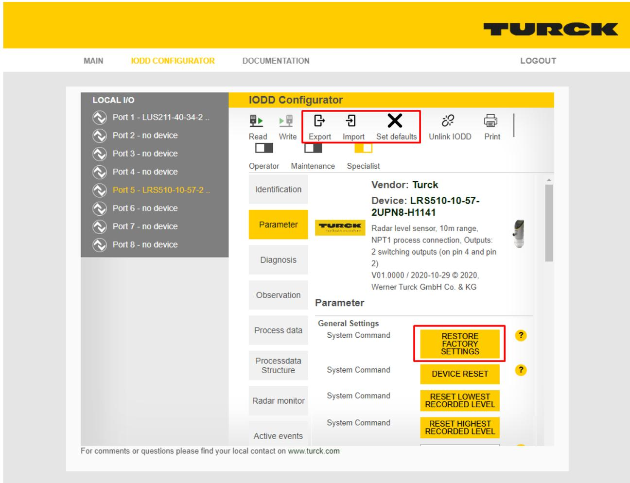
Abb. 71: IODD-Konfigurator: Parameter eines IO-Link-Device
