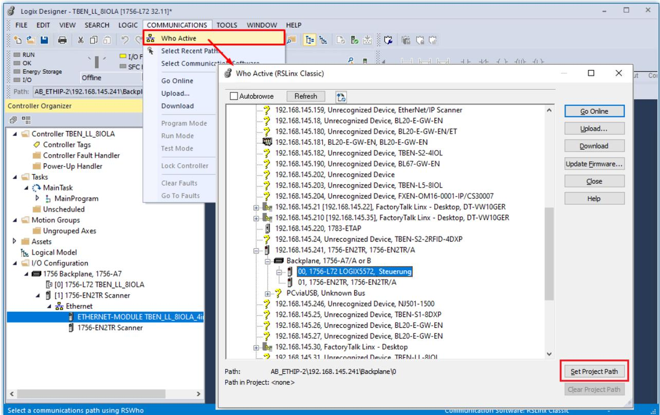
Abb. 66: Kommunikationspfad setzen
