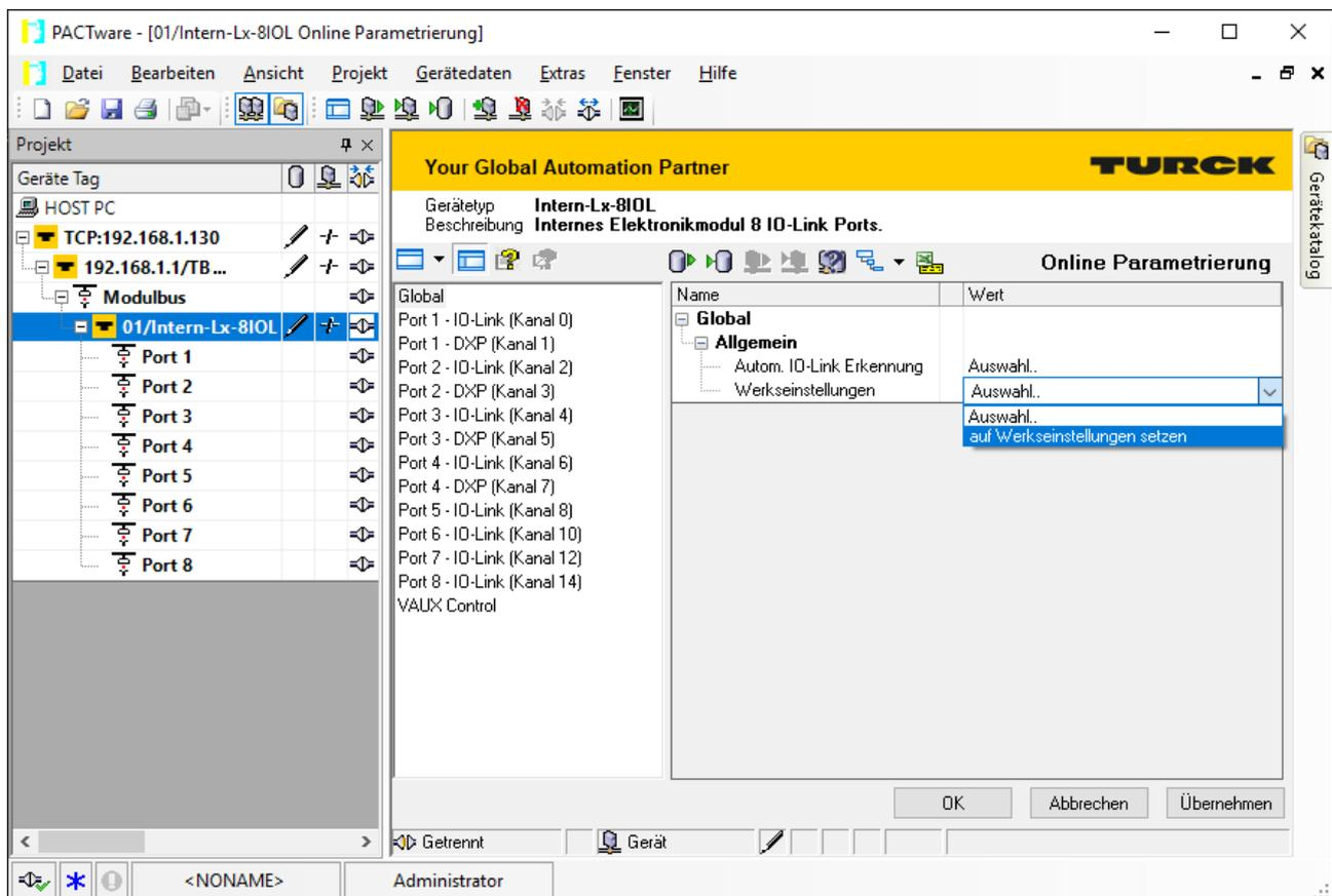
Abb. 79: Beispiel: Gerät über DTM auf Werkseinstellungen zurücksetzen
