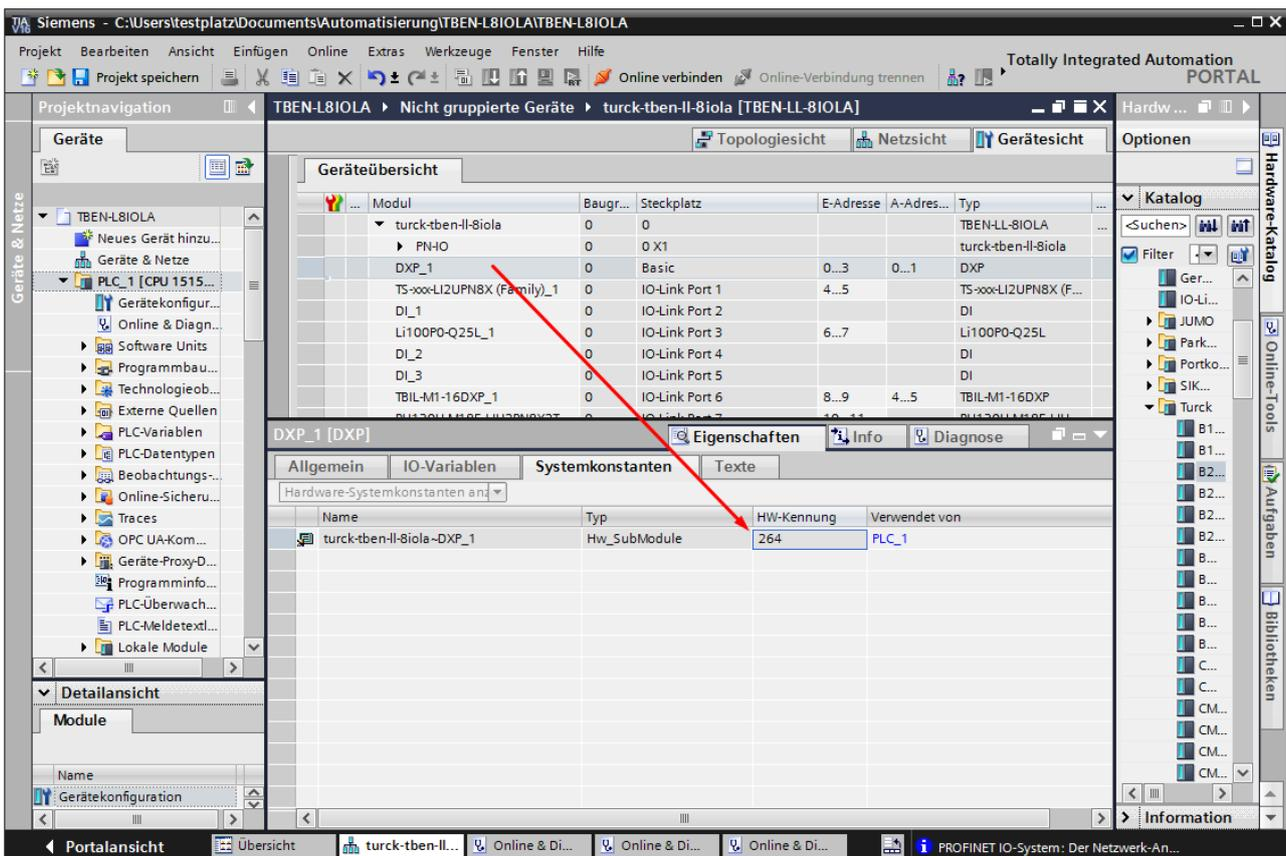
Abb. 40: HW-Kennung: „Basic“-Steckplatz des TBEN-L...-8IOLA
