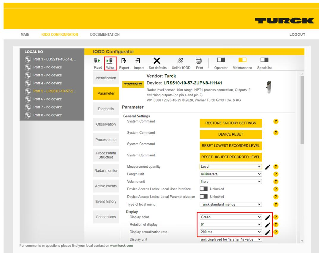
Abb. 81: IODD-Konfigurator – IO-Link-Device parametrieren
