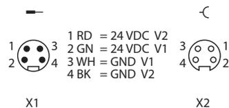
Abb. 13: TBEN-L4... – Pinbelegung Versorgungsspannungsanschlüsse
