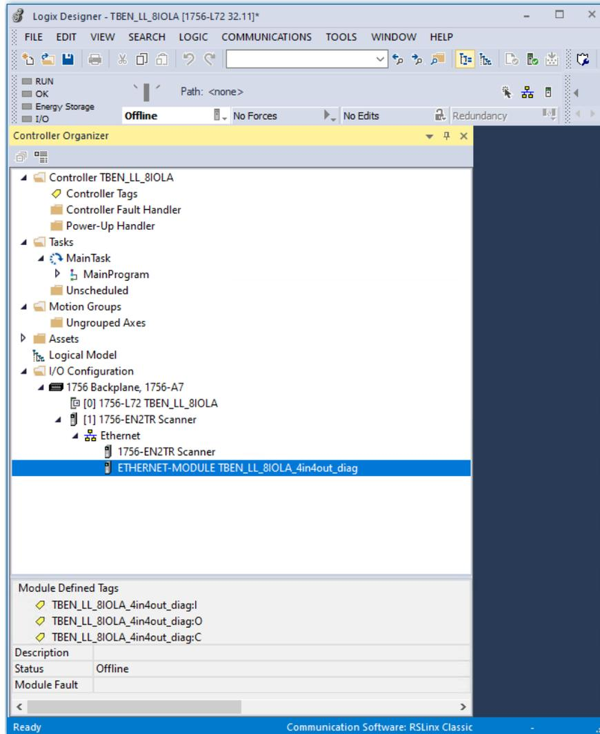
Abb. 62: Logix Designer – vordefinierte Konfiguration von TBEN-LL-8IOLA im neuen Projekt
