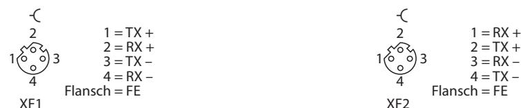
Abb. 11: Pinbelegung Ethernet-Anschlüsse
