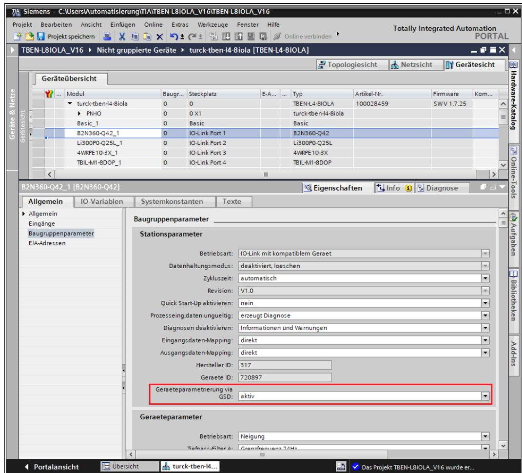
Abb. 73: Beispiel: TIA-Portal, Parameter „Geräteparametrierung via GSD“
