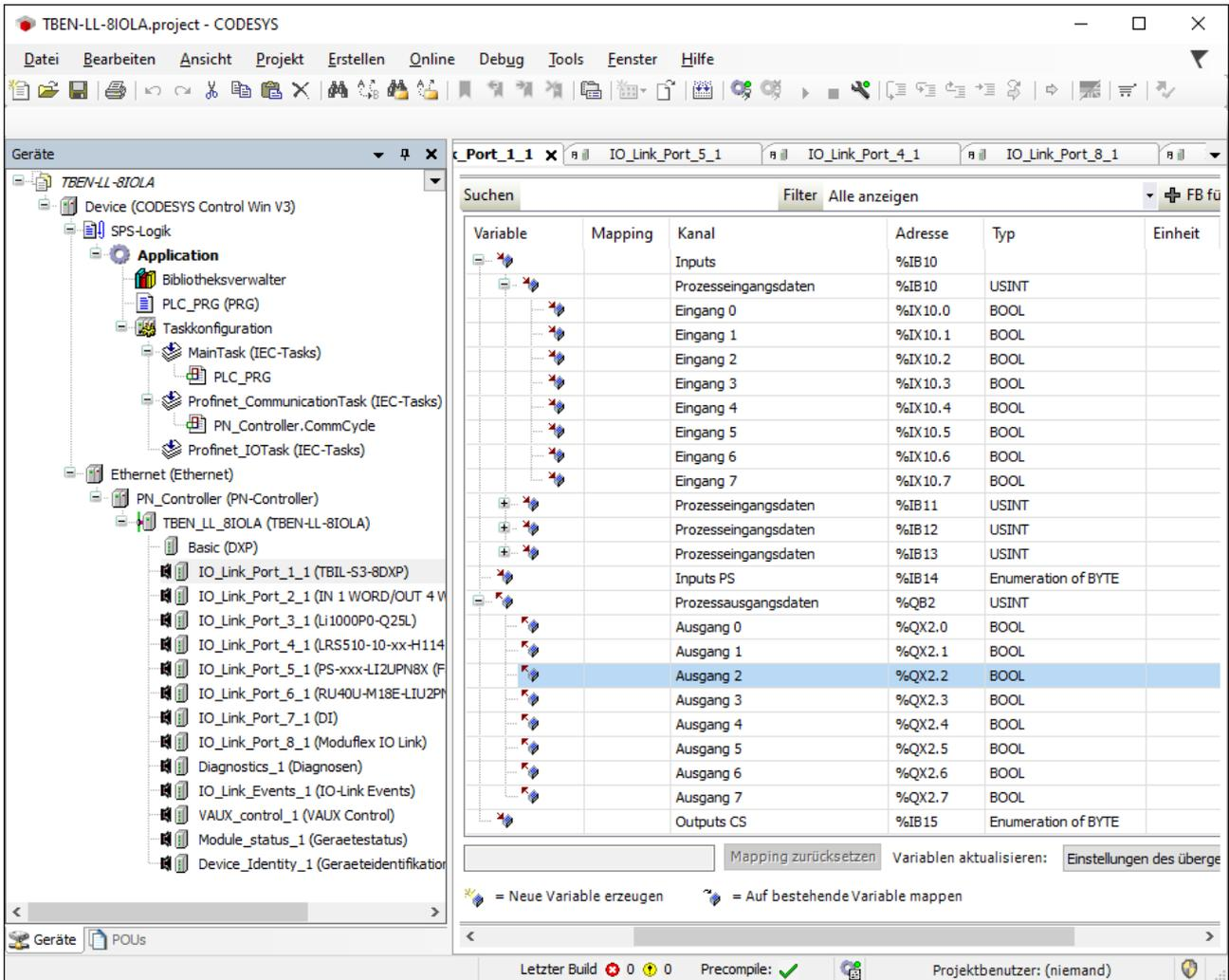
Abb. 76: PROFINET-Engineering (CODESYS): Prozessdatenstruktur IO-Link-Device mit SIDI
