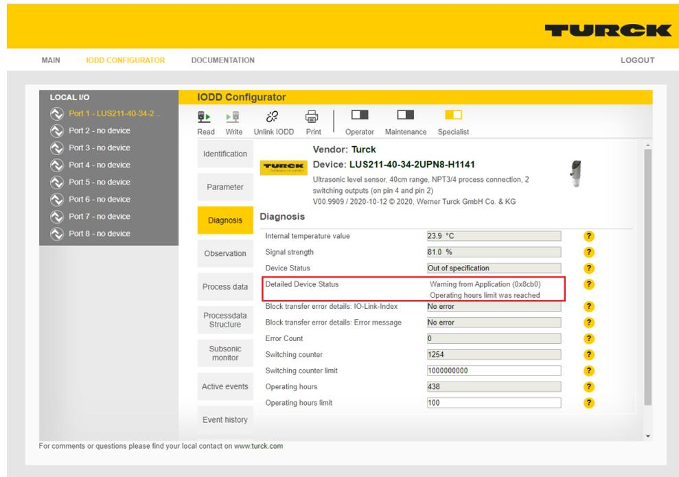
Abb. 90: IODD-Konfigurator: Diagnose am IO-Link-Device
