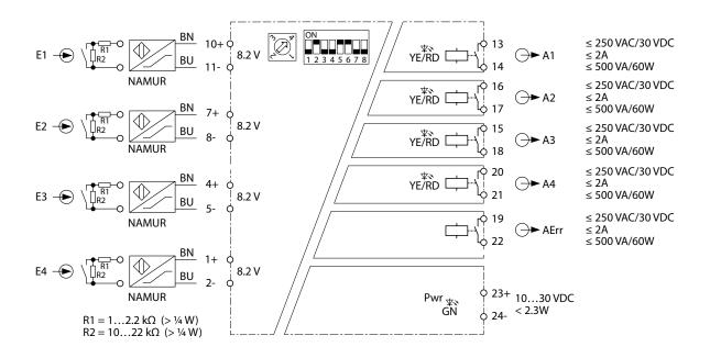
Fig. 7: Wiring diagram IM18-DI03-4S-5R
