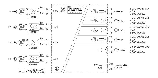
Fig. 6: Wiring diagram IMX18-DI03-4S-5R
