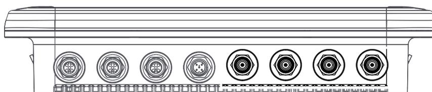
Abb. 8: RP-TNC-Buchsen zum Anschluss externer Antennen
