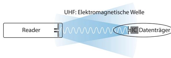
Abb. 2: Funktionsprinzip UHF-RFID
