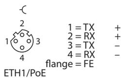
Abb. 5: Pinbelegung Ethernet-Anschlüsse
