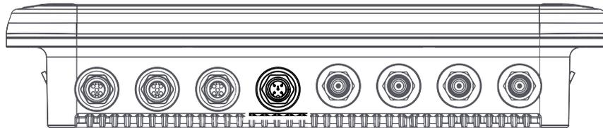
Abb. 6: M12-Steckverbinder zum Anschluss an die Versorgungsspannung
