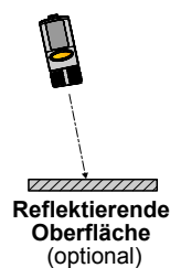
Abbildung 9. Ausrichtung für stark reflektierendes Objekt 2
