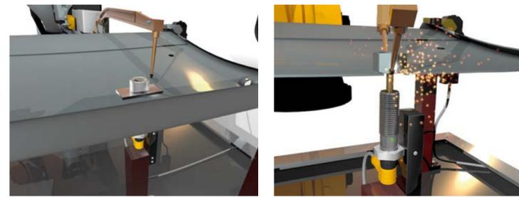
Die im Schweißprozess auftretenden starken Temperaturänderungen werden durch eine Temperaturkompensation abgefangen.
