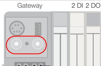
Die Drehkodierschalter sind mit H für High (höherwertige Stelle) und L für Low (niederwertige Stelle) gekennzeichnet.
