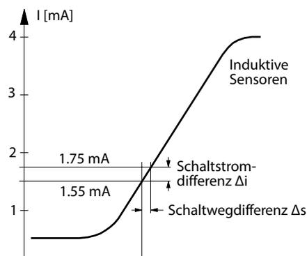
Abb. 1: NAMUR-Kennlinie der induktiven Sensoren gemäß EN 60947-5-6
