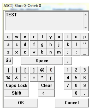
Fig. 29: Interface utilisateur « Clavier » (ASCII)
