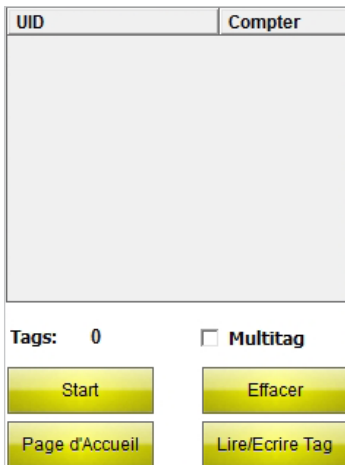
Fig. 38: Interface utilisateur « Inventaire/Sélection Tag UIDs »
