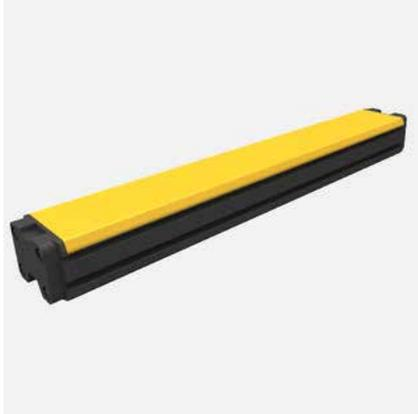
Die induktiven Linearwegsensoren arbeiten berührungslos und verschleißfrei nach einem revolutionären Messprinzip. Die Position wird nicht über einen magnetischen Positionsgeber erfasst, sondern über einen induktiven Schwingkreis. IO-Link dient neben der digitalen Übertragung von Prozesswerten auch zur anwendungsspezifischen Anpassung, beispielsweise durch Einstellung des Messbereichs.
