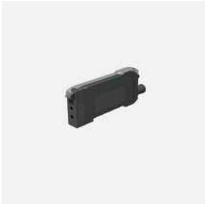
Bei beengten Einbaubedingungen oder bei hohen Temperaturen sind Kunststoff-Lichtwellenleiter die optimale Lösung. Lichtwellenleiter leiten das Licht vom Basisgerät zu einem entfernten Objekt. Mit Einzel-Lichtwellenleitern lassen sich Einweglichtschranken erzeugen, mit Gabel-Lichtwellenleitern Reflexionslichttaster. Über Taster am Gehäuse wird der Sensor eingestellt. Das integrierte Display erleichtert die Einstellung und zeigt die eingestellte Signalstärke an.
