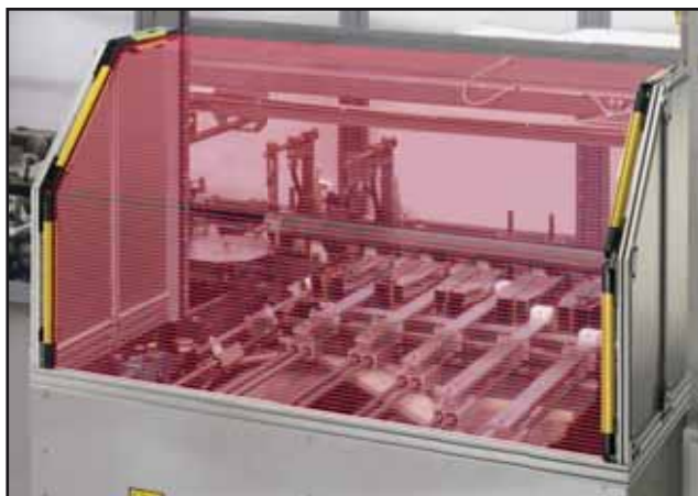
Abbildung 7-1. Mehrere kaskadierte Lichtvorhänge zur Überwachung einer irregulären Öffnung in einer Maschine
