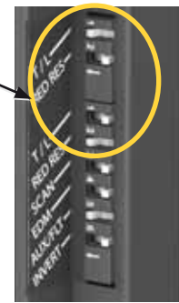
Abbildung 7-7. DIP-Schalter-Konfiguration für Kaskadeninstallation
