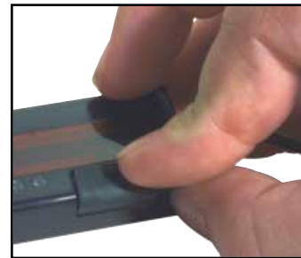
Abbildung 9. Eindrücken der PVA-Abdeckung in die richtige Position
