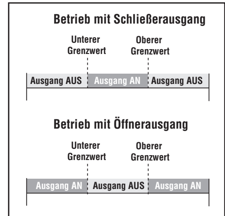
Abbildung 3. Programmierung unabhängiger unterer und oberer Grenzwerte
