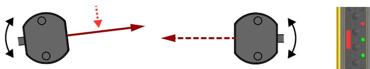
3. Optimieren Sie die Ausrichtung und maximieren Sie die Funktionsreserve.
