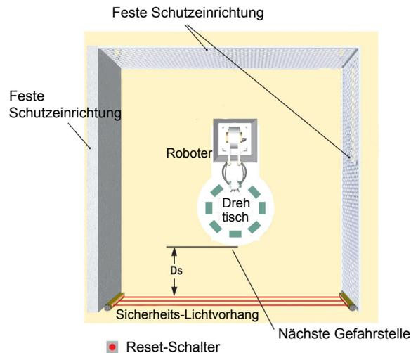
Abbildung 2. Sicherheitsabstand (Mindestabstand) und feste Schutzeinrichtung
