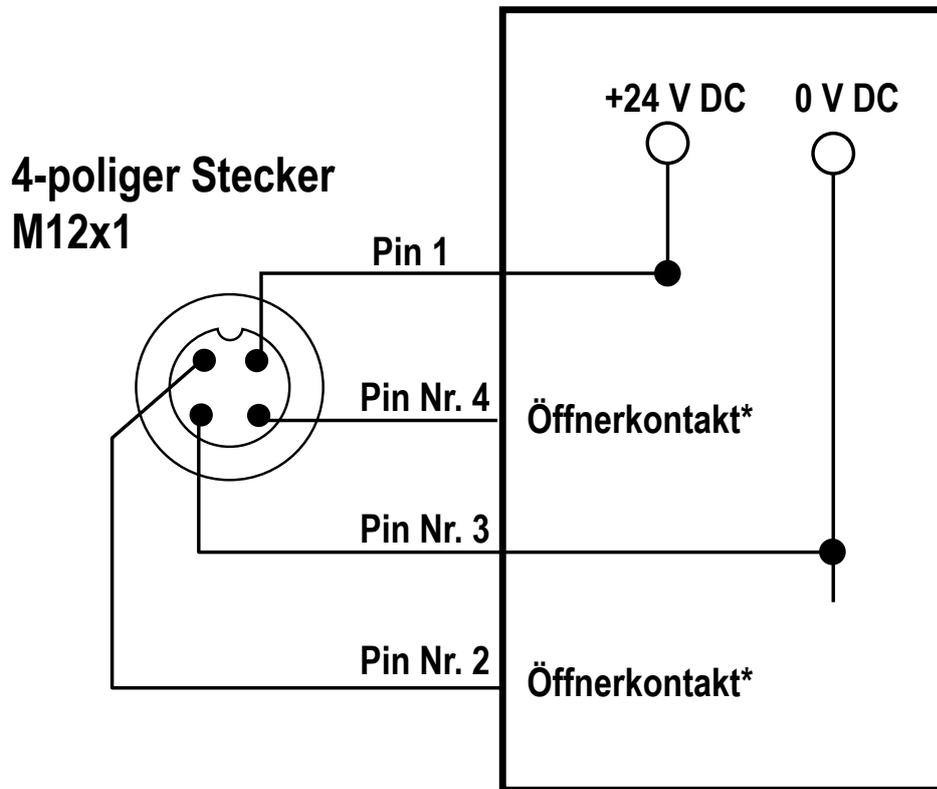
\* Alle als nicht verbunden (not connected = n.c.) abgebildeten Pins sind entweder nicht angeschlossen oder sie sind parallel zu einem gleichfarbigen Leiter des Empfängerkabels geschaltet.
