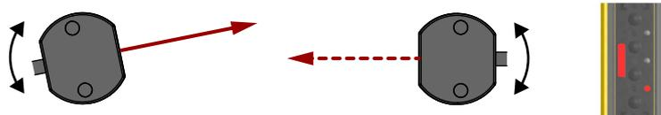
Wenn der Strahl von Kanal 1 nicht ausgerichtet ist, leuchten die Statusanzeige und die Anzeige für Zone 1 rot, und die Anzeigen für die Zonen 2–3 sind ausgeschaltet.
