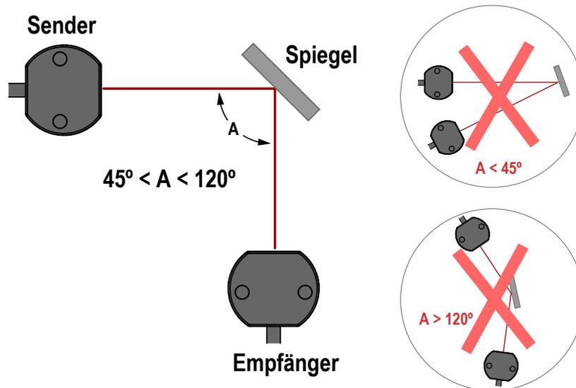
Abbildung 5. Verwendung der Sensoren des SLC4 als Reflexionslichtschranken
