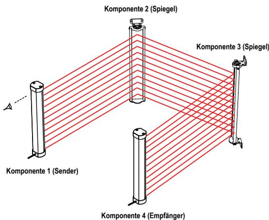
Abbildung 13. Ausrichtung der Umlenkspiegel
