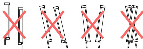
Abbildung 12. Falsche Sensorausrichtung
