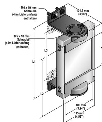
Um die Modelle mit reflektierender Oberfläche aus Edelstahl zu bestellen, fügen Sie die Endung „-S“ hinzu (z. B. **SSM-375-S**); die Reichweitenreduzierung für diese Modelle beträgt ca. 30 % pro Spiegel. Siehe Datenblatt (Ident-Nr. 67200).
