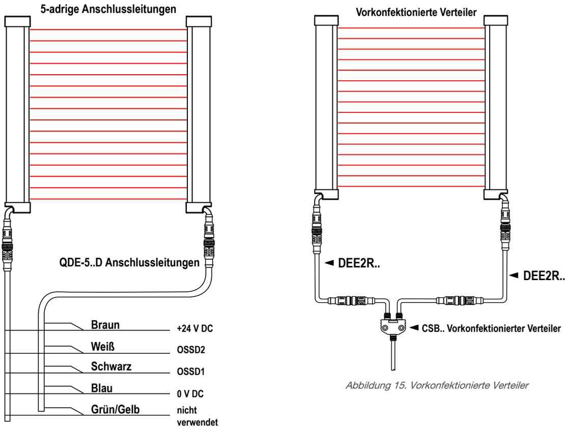
Abbildung 14. Einzelne Anschlussleitungen
