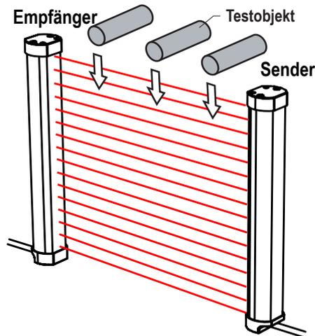
4. Prüfen Sie, ob jedes Mal, wenn das Testobjekt das Schutzfeld unterbricht, mindestens eine Zonenanzeige rot leuchtet. Die rote Zonenanzeige muss sich entsprechend der Position des Testobjekts im Schutzfeld verändern. Die Statusanzeige muss zu Rot wechseln und rot weiterleuchten, solange sich das Testobjekt im Schutzfeld befindet. Andernfalls hat die Anlage den Detektionsfunktionstest nicht bestanden.
