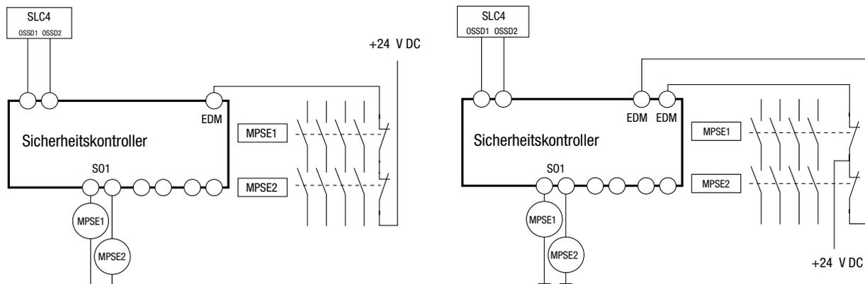
Einkanalige EDM wird für die Überwachung beider MPSE-Rückführsignale verwendet. Schließt sich einer der beiden Kanäle nicht, wechselt das System in einen Sperrzustand.
