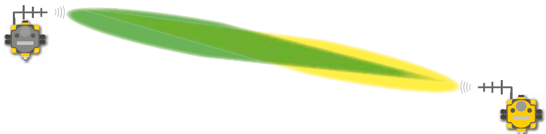
Mit zunehmender Verstärkung der Yagi-Antenne wird das Funksignal entlang eines bestimmten Wegs stärker fokussiert.
