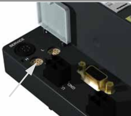
Abbildung 20: Dezimal-Drehkodierschalter zur Adressierung am PROFIBUS-DP
