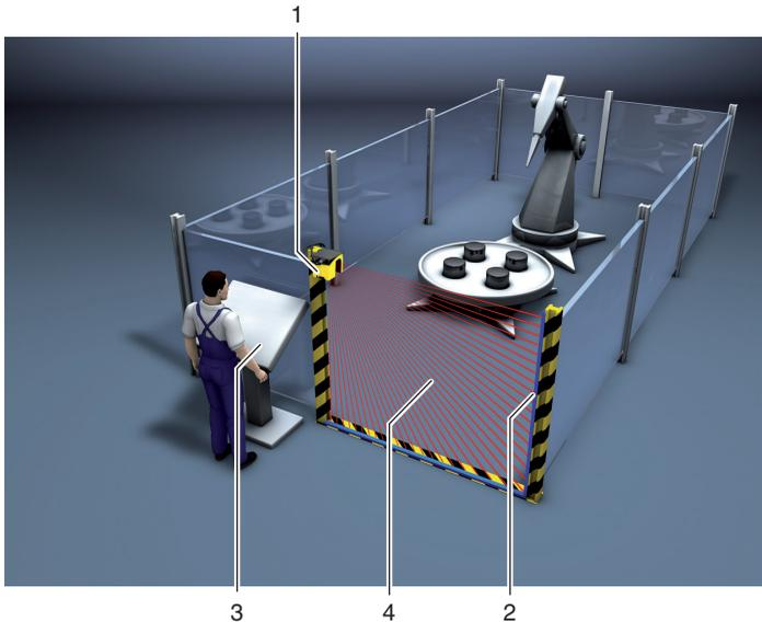
Bild 5.3: Stationäre Zugangssicherung
