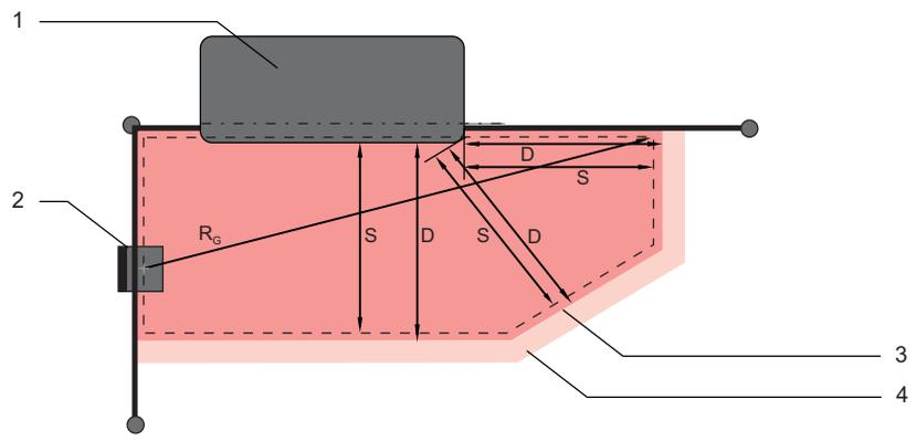
Bild 6.12: Festlegung der Schutzfeldkontur für ein stationäres, horizontales Schutzfeld
