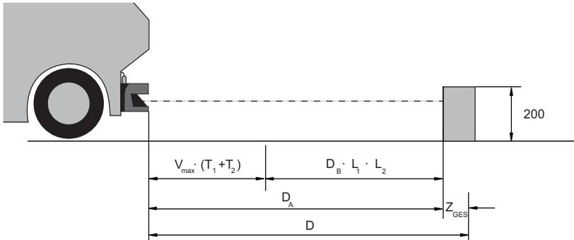
Bild 6.17: Mobile Gefahrbereichssicherung, Berechnung der erforderlichen Mindestdistanz D
