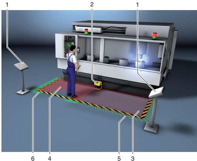
Bild 5.1: Stationäre Gefahrbereichssicherung mit zwei alternierenden Arbeitsbereichen
