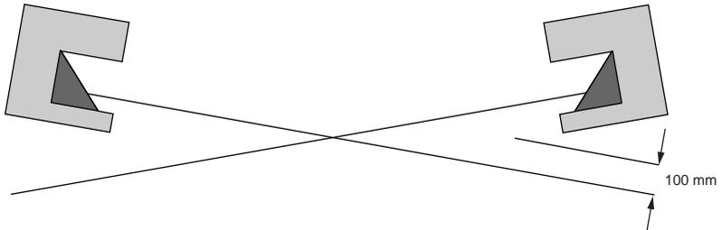
Bild 6.6: Montage gegenüberliegend, ohne Höhenversatz, gekreuzte Ausrichtung
