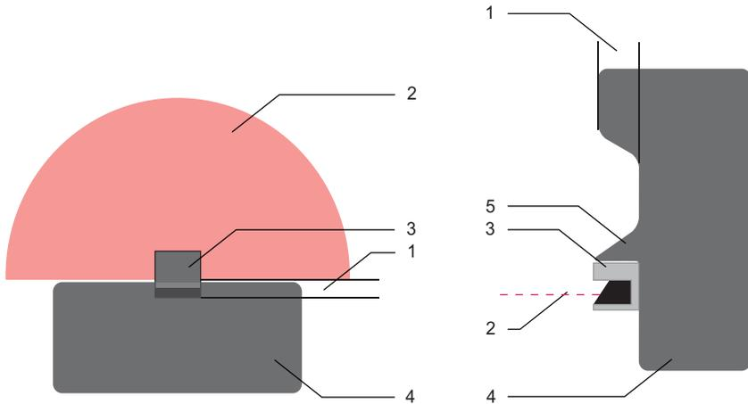
Bild 6.2: Hintertrittsicherheit durch Einsenken in die Maschinenkontur
