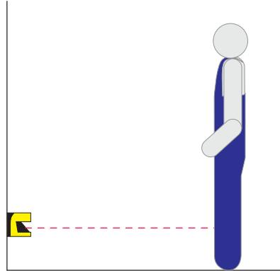
Bild 6.9: Strahlebene 300 mm hoch, Auflösung 70 mm notwendig
