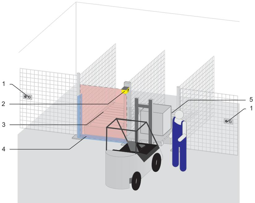
Bild 6.15: Stationäre Zugangssicherung, vertikales Schutzfeld
