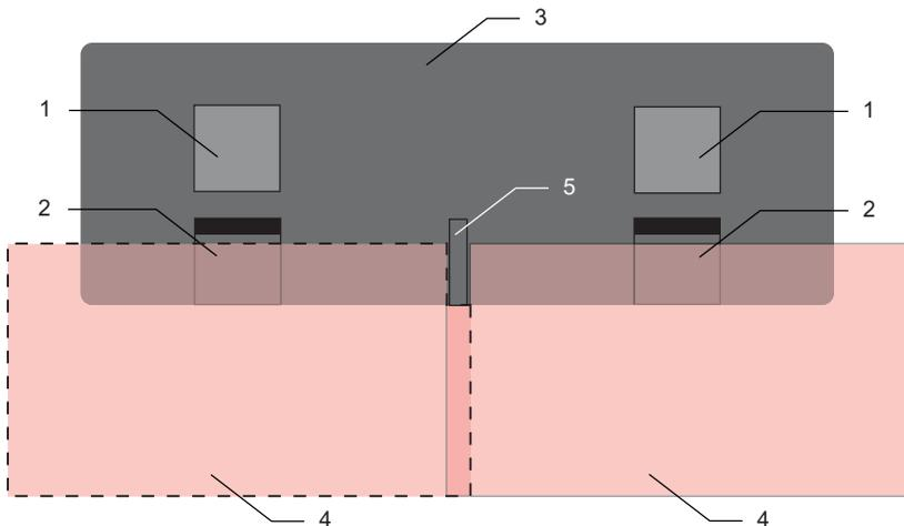
Bild 6.3: Abschirmung verhindert gegenseitige Beeinflussung nebeneinander angeordneter Sicherheits-Sensoren
