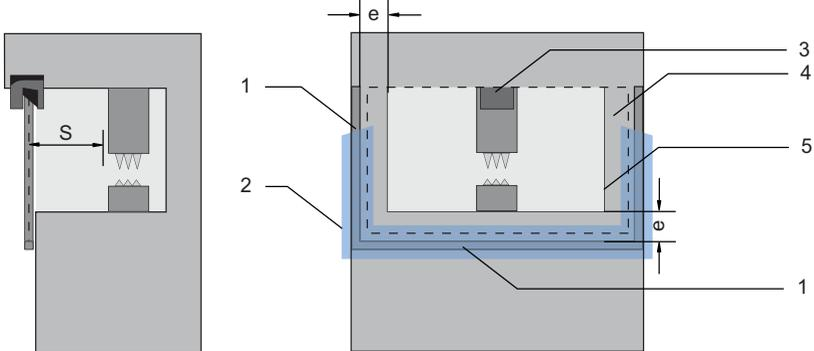
Bild 6.14: Festlegen der Schutzfeld- und Referenzkontur, stationäre Gefährdungs- und Stellensicherung, vertikales Schutzfeld
