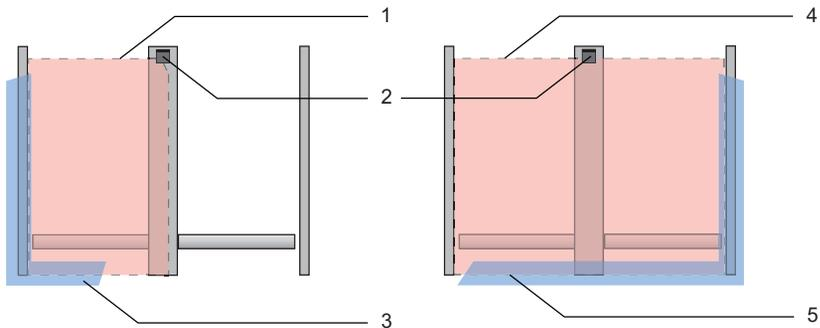
Bild 6.16: Festlegen der Schutzfeld- und Referenzkonturen, stationäre Zugangsicherung, vertikales Schutzfeld
