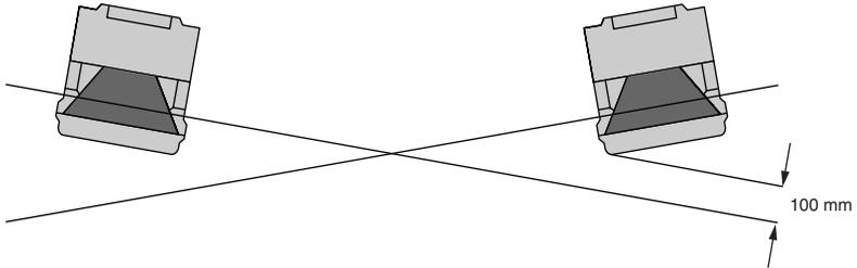
Bild 6.5: Montage nebeneinander, ohne Höhenversatz, gekreuzte Ausrichtung
