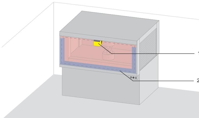
Bild 6.13: Der Sicherheits-Sensor übernimmt die Stopp auslösende und Anwesenheit erkennende Funktion, wenn das Schutzfeld nicht hintertretbar ist.
