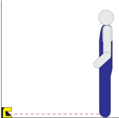
Bild 6.8: Strahlebene bodennah, Auflösung 50 mm notwendig
