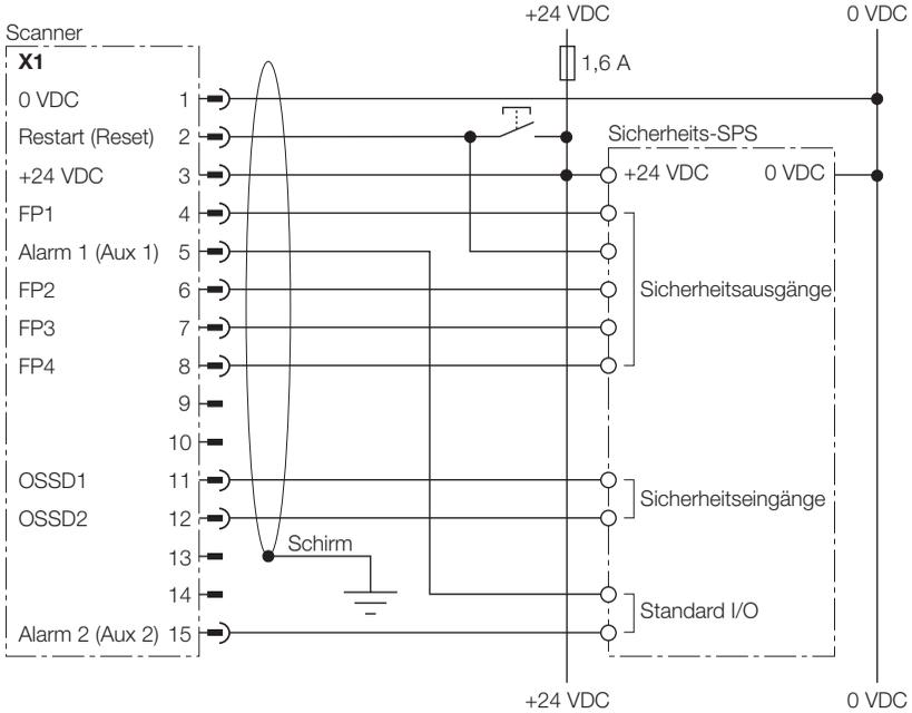
Bild 8.6: Beispiel einer Beschaltung mit einer sicheren SPS mit entsprechendem Sicherheitsniveau (min. Kat. 3, EN 954) und Feldpaarumschaltung
