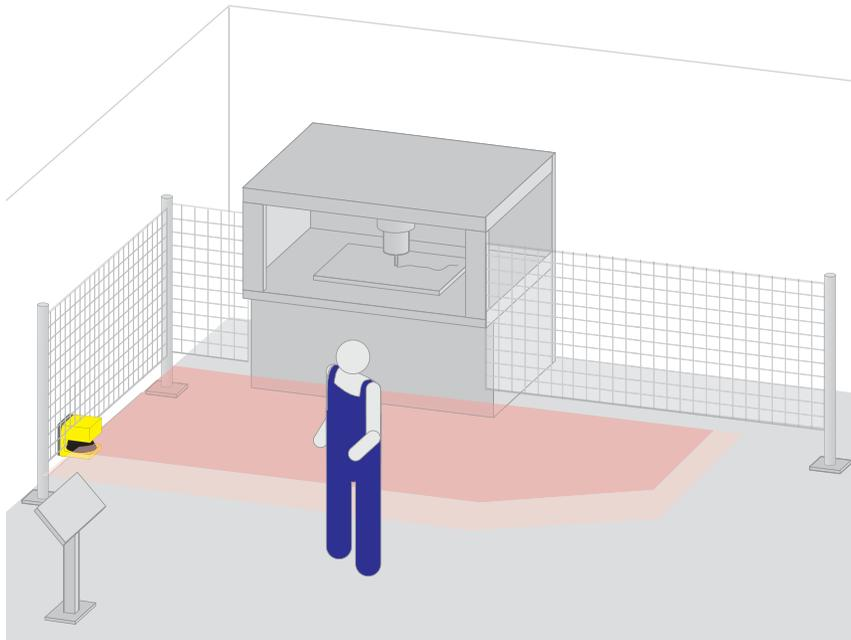
Bild 6.7: Sicherheits-Sensor übernimmt die Stopp auslösende und, bei nicht hintertretbarem Schutzfeld, eine Anwesenheit erkennende Funktion
