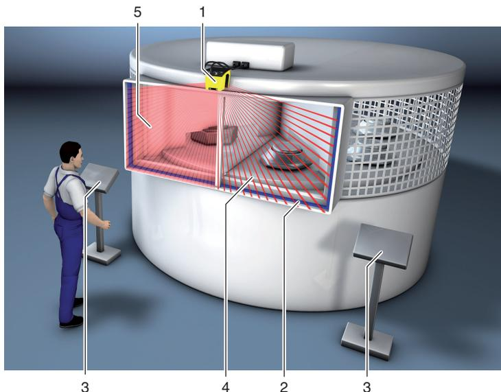
Bild 5.2: Stationäre Gefahrstellensicherung mit Schutzfeldumschaltung
