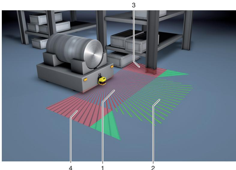
Bild 5.4: Mobile Gefahrenbereichssicherung
