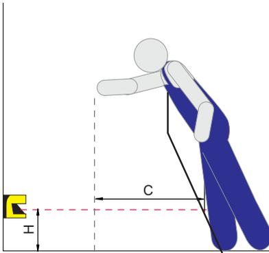
Bild 6.10: Strahlebene  $H = 300$  mm,
