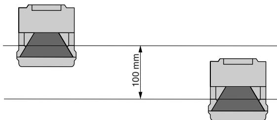
Bild 6.4: Montage mit Höhenversatz, parallele Ausrichtung
