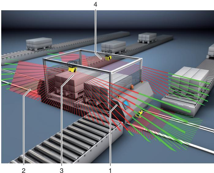
Bild 5.5: Mobile Seitenabsicherung an Verschiebewagen
