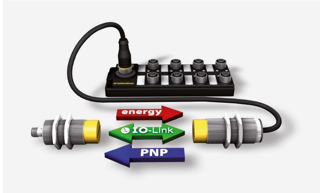
Mit berührungslosen induktiven Kopplern bietet Turck eine verschleißfreie Alternative zur klassischen Verbindungstechnik. Die Koppler-Sets des NIC-Systems bestehen jeweils aus einem Primärteil auf der Steuerungsseite und einem Sekundärteil auf der Sensor-/Aktorseite der Verbindung. Die NIC-Koppler übertragen
