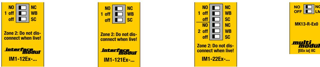
Abb. 10: Einstellung über DIP-Schalter
