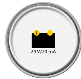
Spannungsversorgung 2-Leiter 4...20 mA
