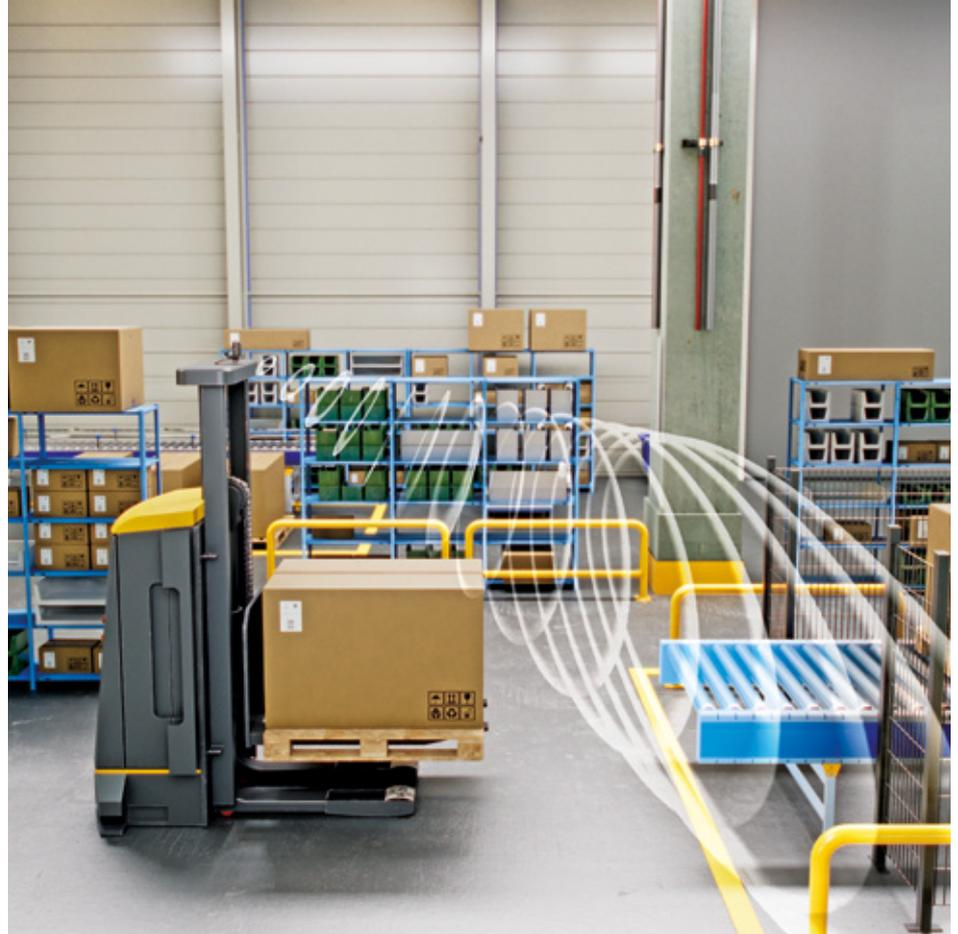
Maßarbeit: Der Radarscanner oben am Stapler erfasst auch die Höhe der Rollenbahn
