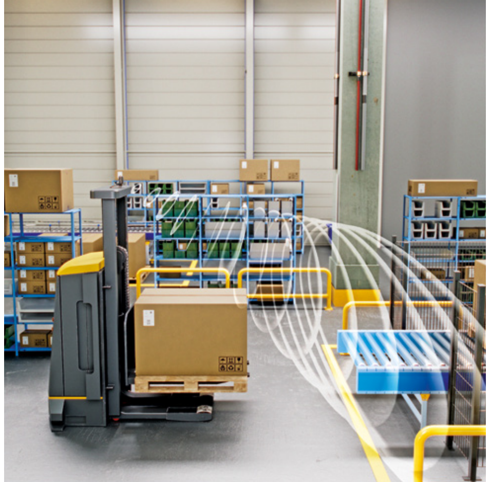
Maßarbeit: Der Radarscanner oben am Stapler erfasst auch die Höhe der Rollenbahn
