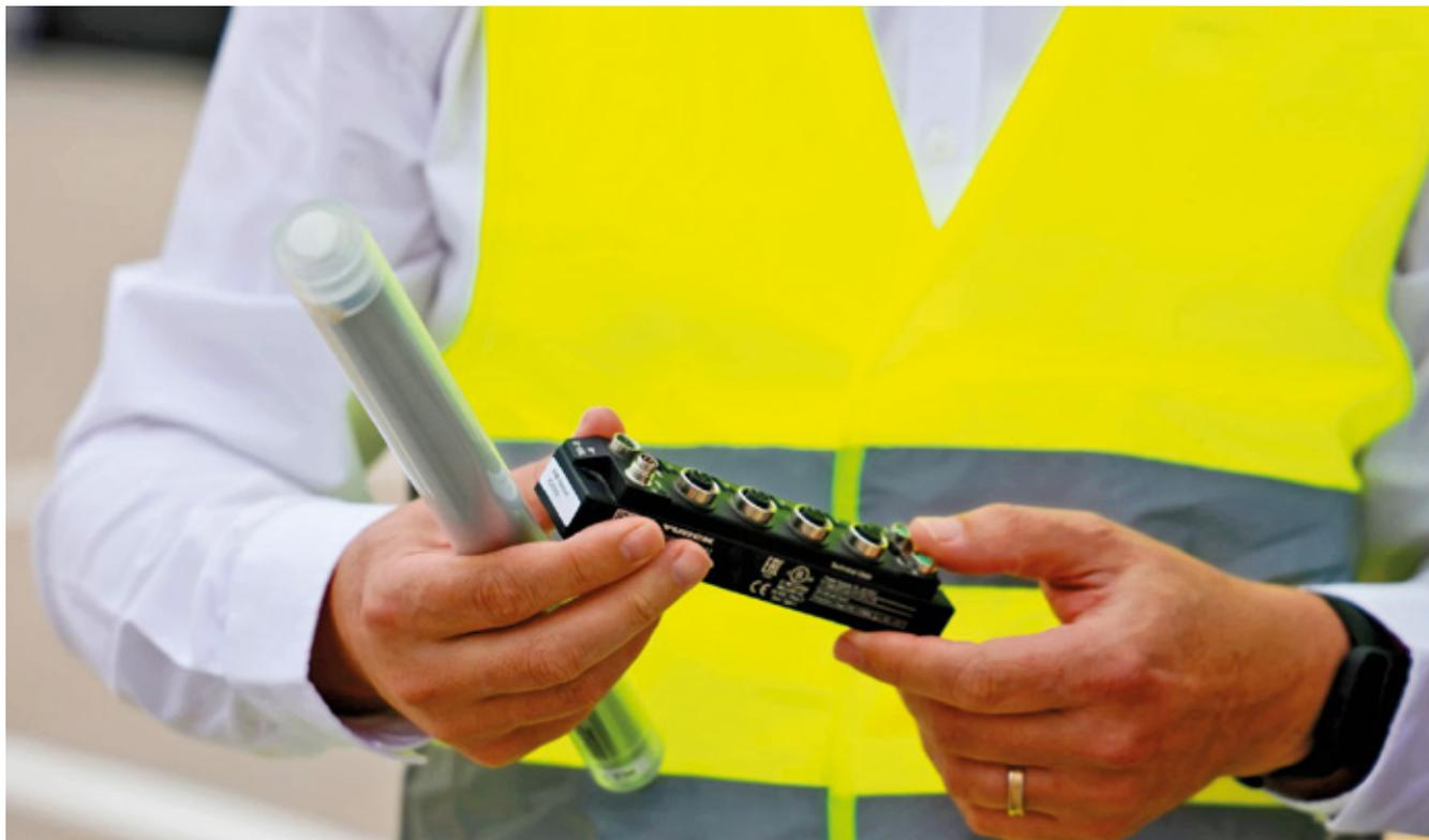
Turck ultrakompaktes Ethernet-Multiprotokoll-I/O-Modul TBEN-S2-4IOL ist als IO-Link Master das Herzstück des Verkehrssteuerungssystems bei Ardo
