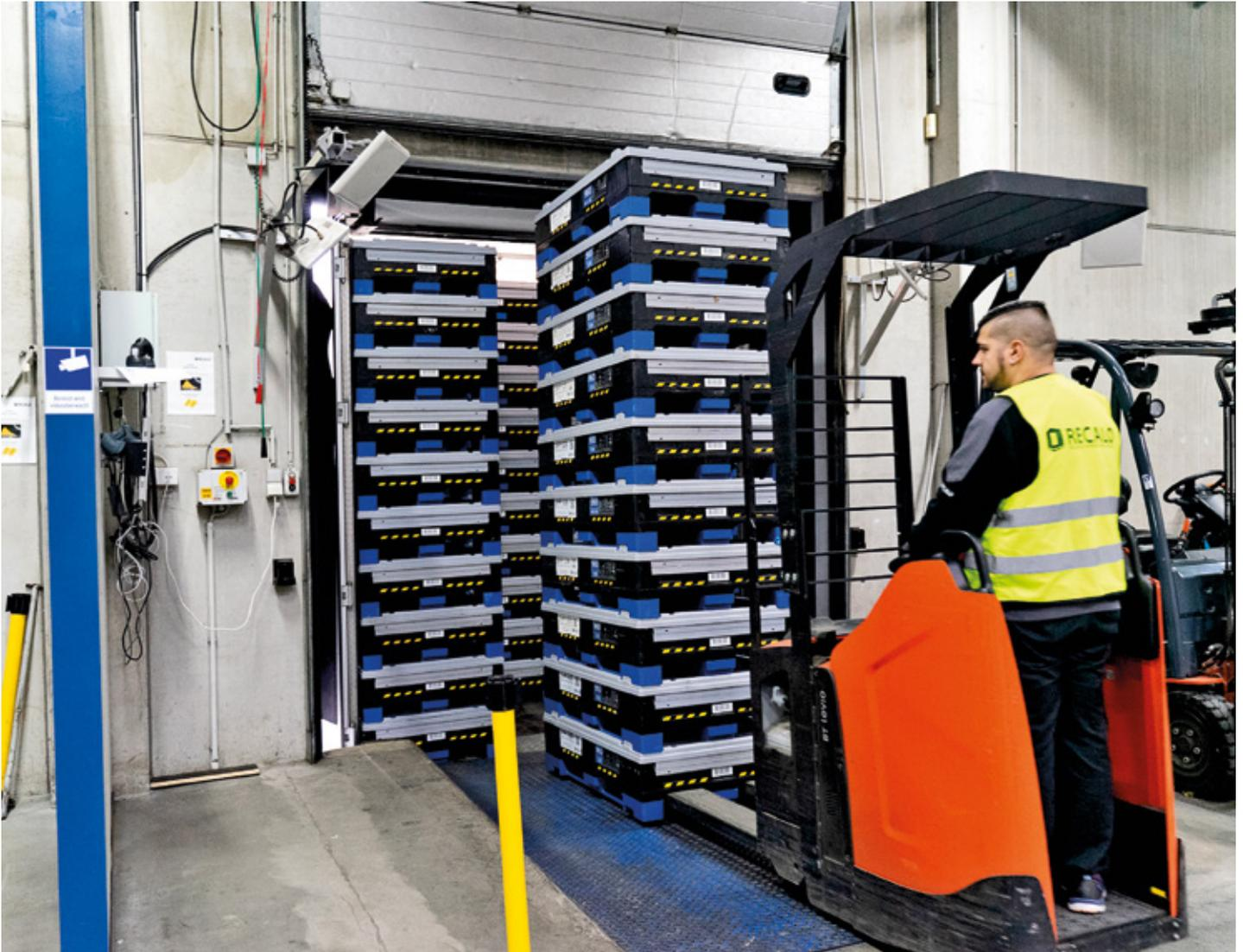
Die gestapelten RTIs werden beim Befüllen des LKW komplett erfasst, wenn der Stapler das Tor durchfährt
