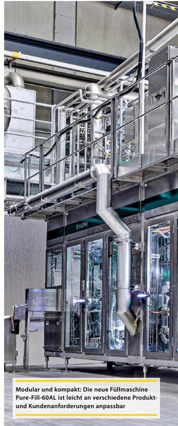
**Modular und kompakt: Die neue Füllmaschine Pure-Fill-60AL ist leicht an verschiedene Produkt- und Kundenanforderungen anpassbar**
