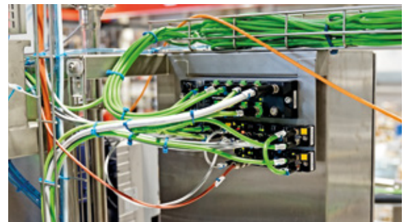
Turcks Ethernet-Switch TBEN-LL-SE-M2 (oben) sorgt mit acht 100-Mbit- und zwei Gbit-Ports für eine schnelle und sichere Datenübertragung in der Maschine
