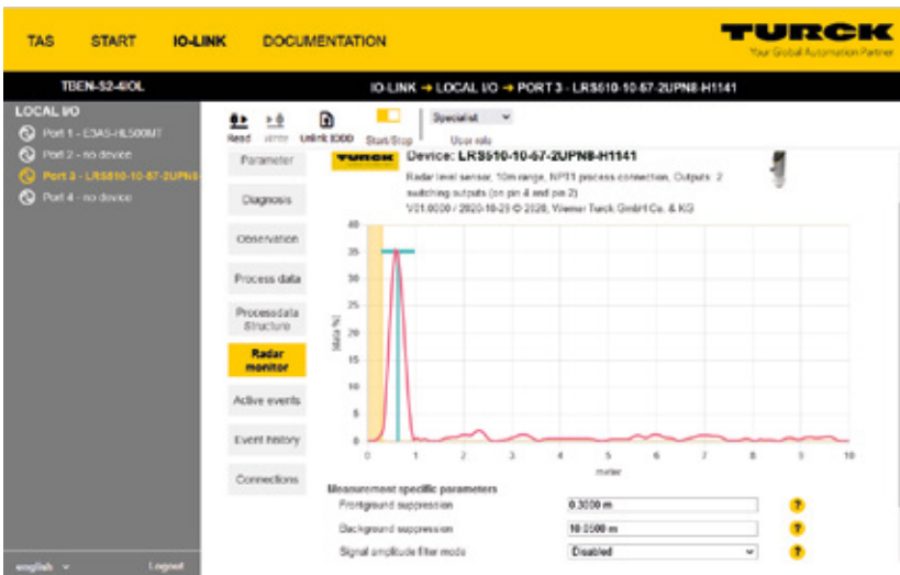
TAS Desktop: Der Radar Monitor erleichtert die Einrichtung der Sensoren durch Echtzeit-Visualisierung der Signalkurve
