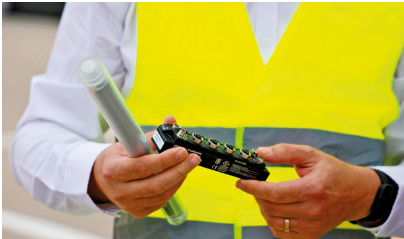
Turck ultrakompaktes Ethernet-Multiprotokoll-I/O-Modul TBEN-S2-4IOL ist als IO-Link Master das Herzstück des Verkehrssteuerungssystems bei Ardo
