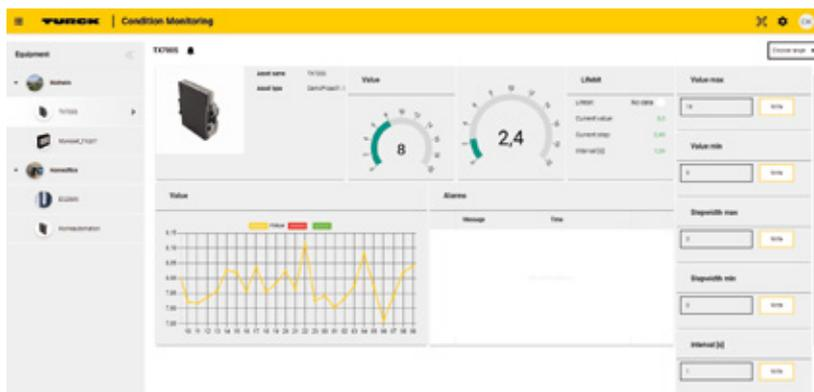
TAS Cloud: Das Dashboard liefert Einblicke in den Anlagenzustand, der durch Turcks IIoT-Gateway TX7005 überwacht wird
