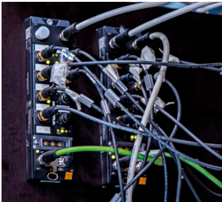
Die kompakten Block-I/O-Module TBEN-LL-16DXP führen die Sensordaten zusammen und übertragen sie in Echtzeit
