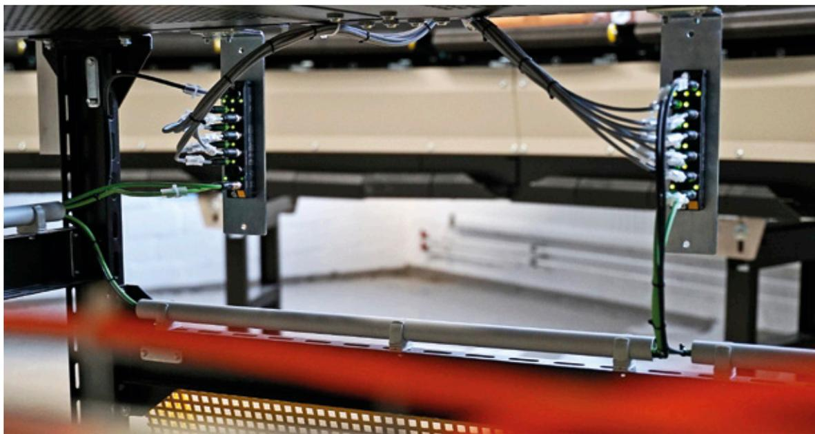
Um trotz der Vielzahl der in Intralogistiksystemen anfallenden Sensor- und Aktorsignale effizient arbeiten zu können, hat Turck ein Blockmodul mit universellen Kanälen entwickelt, die variabel als Ein- oder Ausgang nutzbar sind
