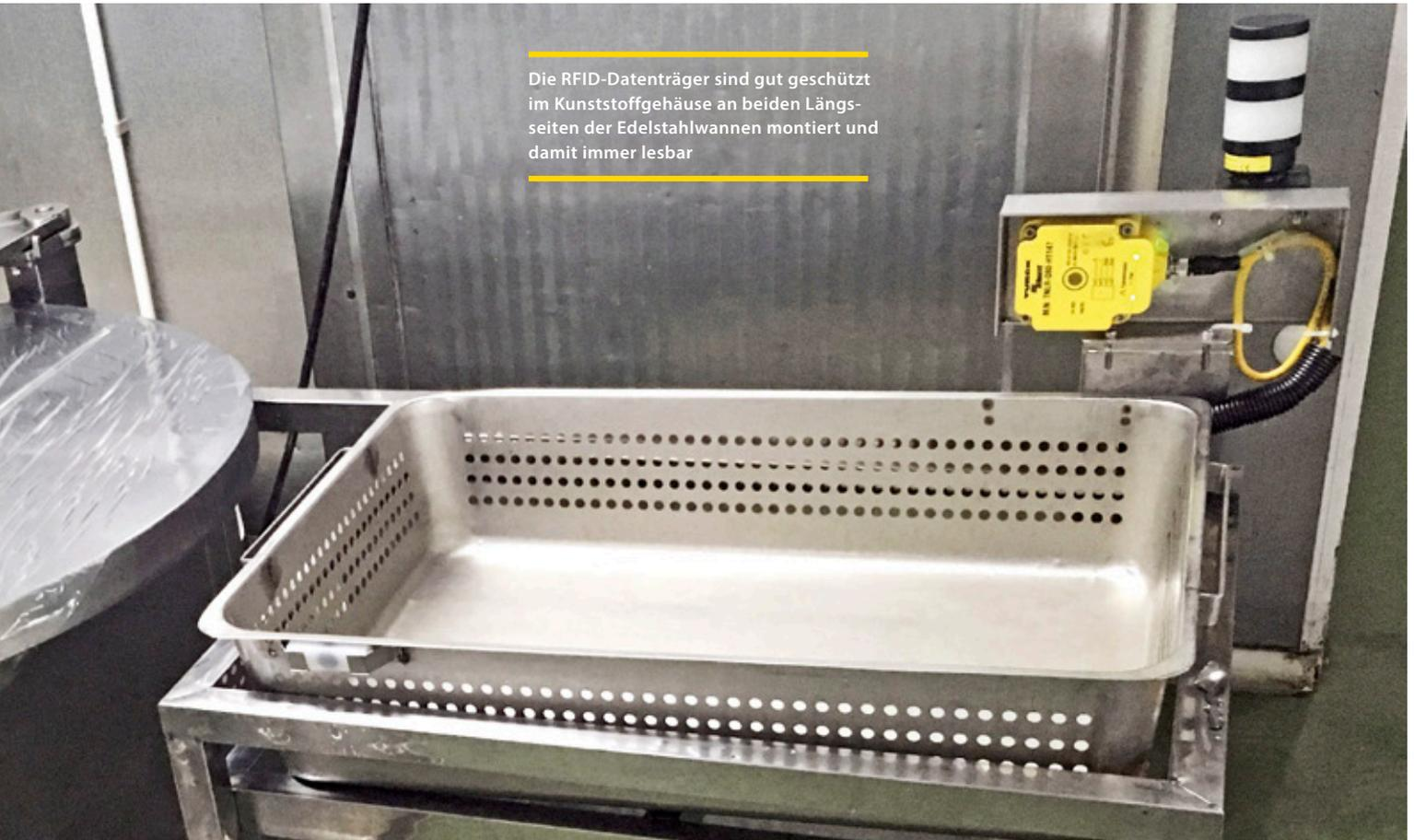
Die RFID-Datenträger sind gut geschützt im Kunststoffgehäuse an beiden Längsseiten der Edelstahlwannen montiert und damit immer lesbar
