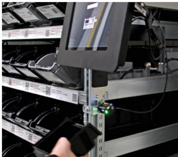
Durch Scannen eines QR-Codes am Sichtlagerkasten führt das hausinterne Assistenzsystem iCParts Mitarbeiter per Leuchtsignal sofort zum gesuchten Artikel
