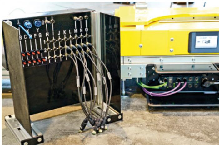
Turck's TBEN-L-PLC steuert die Krups-Förder-technikmodule – zur Peripherie kommuniziert die robuste IP67-Steuerung per CAN, zur Anlagensteuerung über Profinet oder Ethernet/IP
