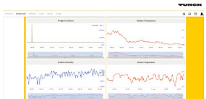
Predictive Maintenance: Die Betrachtung von Temperatur und Feuchte über lange Zeiträume erlaubt Rückschlüsse auf Verschleiß der Dichtungen
