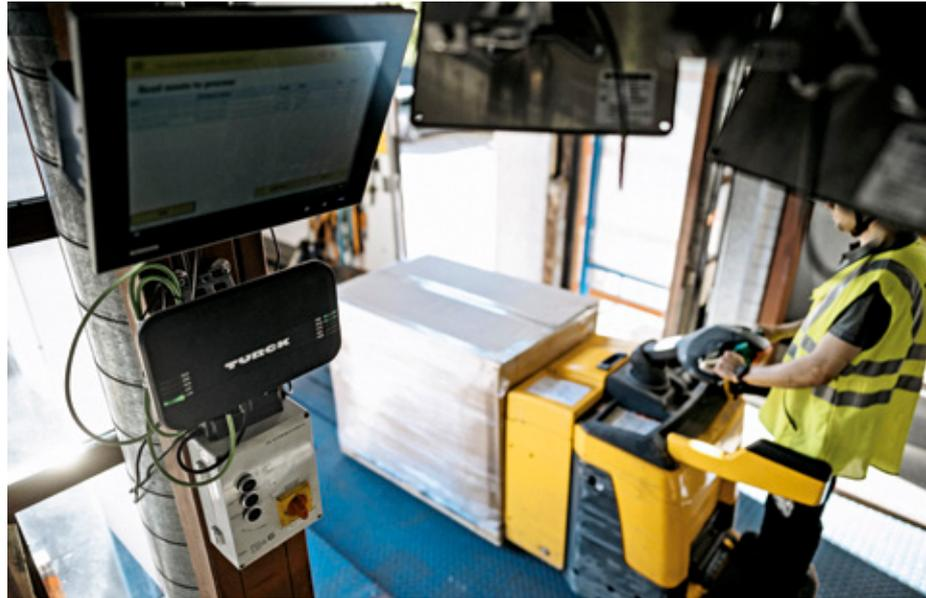
Die RFID-Reader sind so konzipiert, dass sie mehrere RFID-Tags gleichzeitig lesen können, z. B. eine Palette mit RTIs, die sich durch ein Tor mit RFID-Gate bewegt
