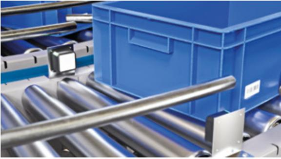
Barcodes sind eine relativ günstige Identifikationstechnik, die aber schwerer zu automatisieren ist – insbesondere wenn mehrere Behälter gleichzeitig eingelesen werden sollen
