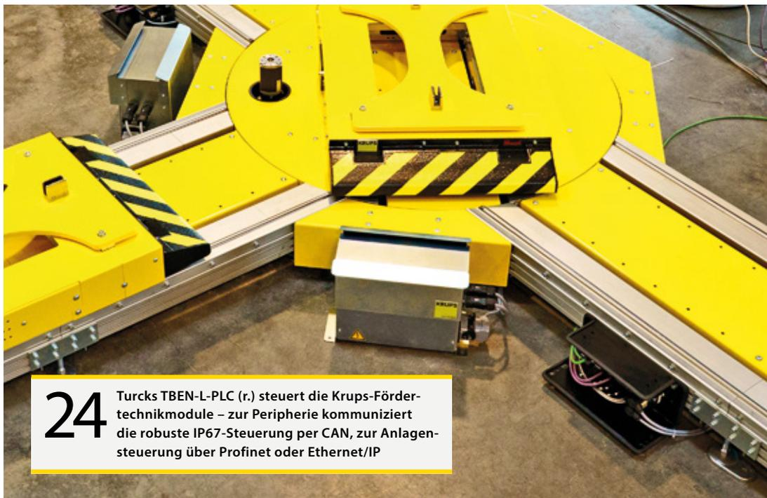
**24** Turcks TBEN-L-PLC (r.) steuert die Krups-Förder-technikmodule – zur Peripherie kommuniziert die robuste IP67-Steuerung per CAN, zur Anlagensteuerung über Profinet oder Ethernet/IP
