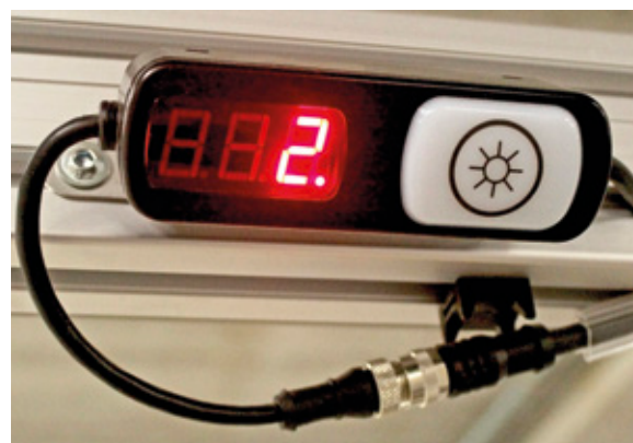
Die PTL110 mit Touch-Button, Sensor und Display gewährleisten eine zuverlässige Bedienung
