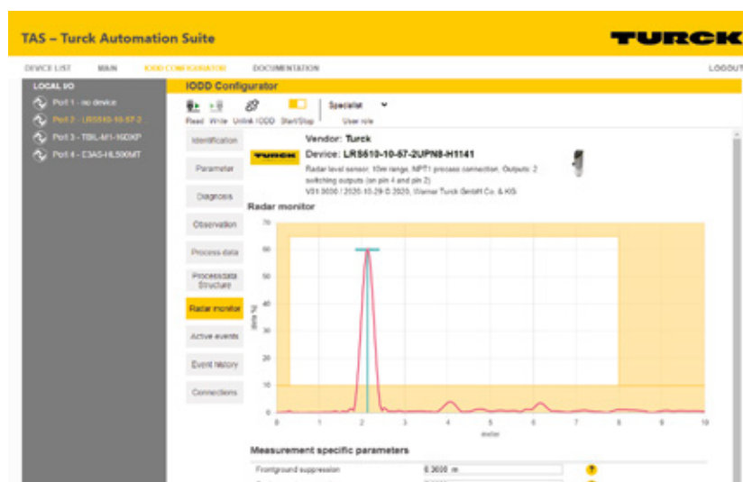
Der Radar Monitor erleichtert die Einrichtung der Sensoren durch Echtzeit-Visualisierung der Signalkurve
