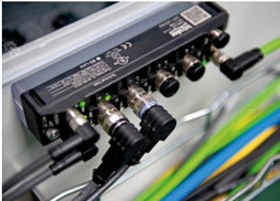
ISC CAM: Die dezentrale Intralox-Logik auf Turcks robusten TBEN-S-Blockmodulen ermöglicht ein variables Anlagenlayout ohne aufwendige Schaltschrankinstallation
