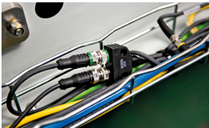
Eine schnelle und problemlose Verkabelung versprechen die M12-Steckverbinder mit farbcodierten Ringen für Poka-Yoke-Verbindungen
