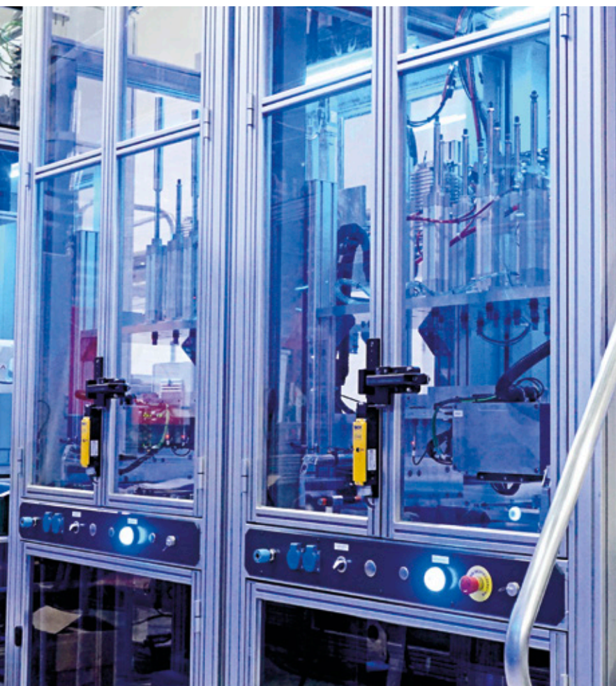
WLS27-LED-Linienleuchten stellen den jeweiligen Status eines Moduls farbig dar
