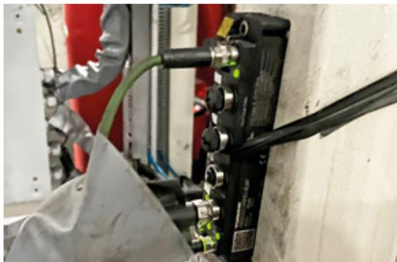
Turcks TBEN-S-RFID-Modul überzeugt mit einem Datenpuffer von 16 Kilobyte
