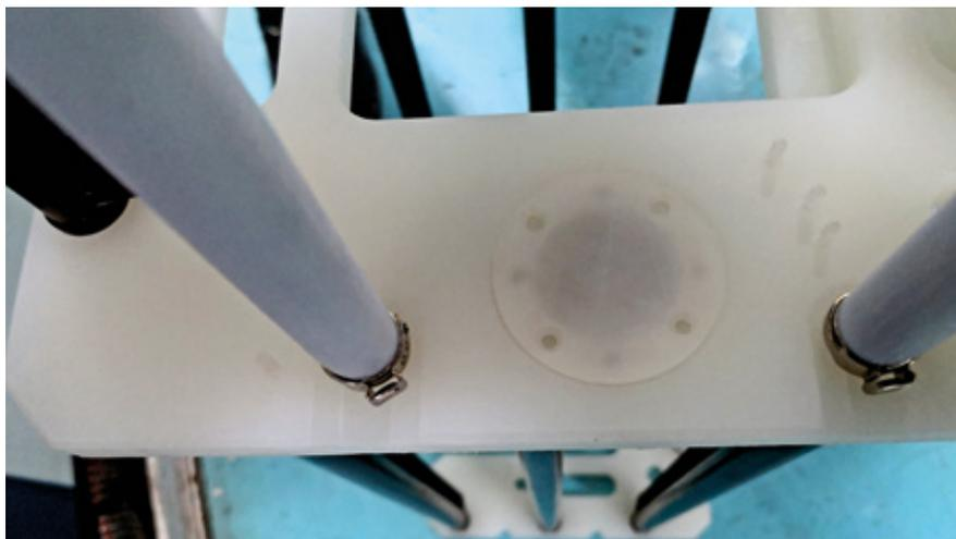
Über den integrierten RFID-Tag kann jeder Waferträger eindeutig identifiziert und einem Produktionsauftrag zugeordnet werden
