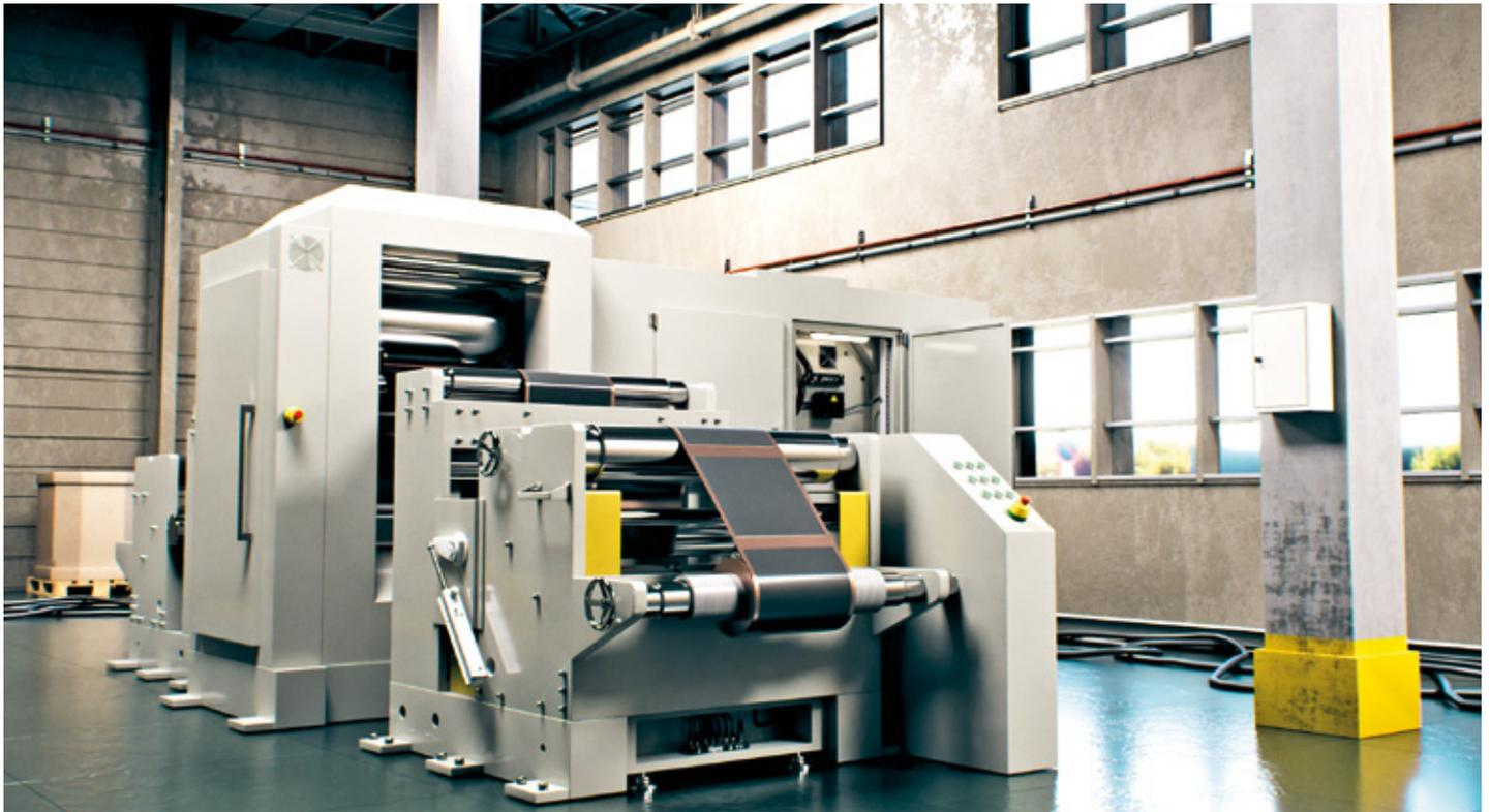
Der Walzendruck beim Kalandrieren ist für die Qualität der Batteriezellen entscheidend, Turcks Fluidsensoren erfassen die Messwerte kontinuierlich
