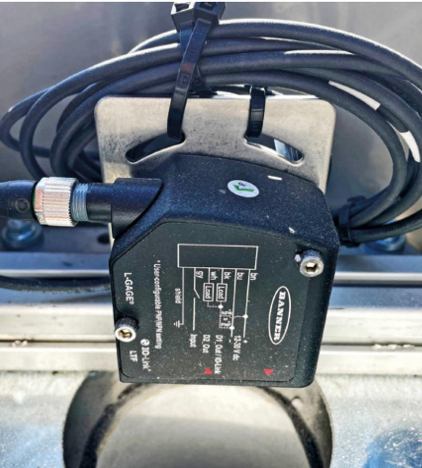
**Der robuste Lasersensor LTF12 mit IO-Link-Ausgang hat eine Reichweite von bis zu 12 m bei einer Auflösung von 0,3 bis 3 Millimeter**
