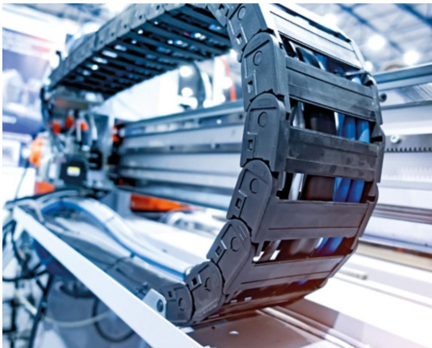
**Vor allem in Schleppketten werden Leitungen stark beansprucht – konstantes Condition Monitoring mit dem M12Plus ermöglicht den rechtzeitigen Austausch ausfallgefährdeter Leitungen**
