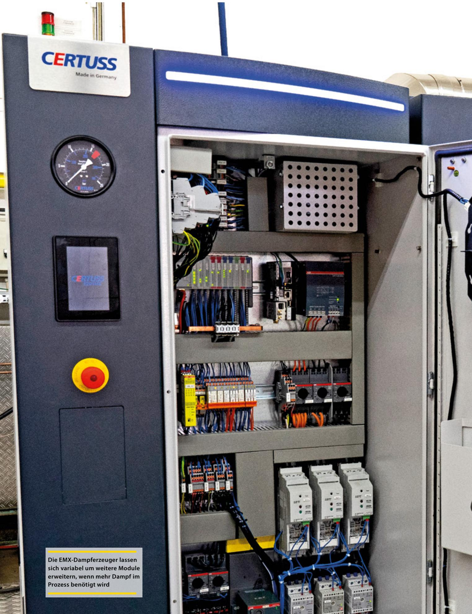
Die EMX-Dampferzeuger lassen sich variabel um weitere Module erweitern, wenn mehr Dampf im Prozess benötigt wird
