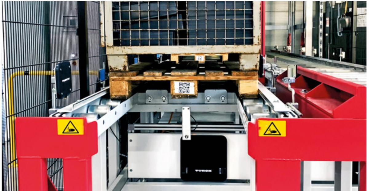
Am Fördersystem erfassen externe RFID-Nahfeldantennen ausschließlich die unmittelbar vor ihnen befindliche Palette
