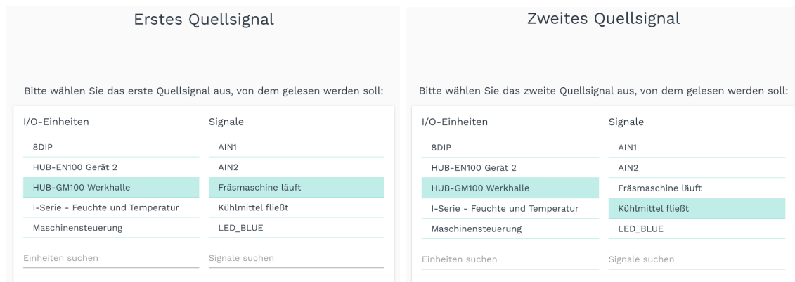
Abb. 65: I/O-Verwaltung > Synthetische Signale > Synthetisches Signal bearbeiten (beispielhafte Darstellung) Beispiel: Wenn der Signalwert des Digitaleingangs 1 (DIO1) ausgibt, dass die „Fräsmaschine läuft“ und der Signalwert des Digitaleingangs 2 (DIO2) ausgibt, dass das „Kühlmittel fließt“, dann wird das hier hinzugefügte synthetische Signal erzeugt, welches einen (wie auch immer definierten) Maschinenzustand ausgibt.
